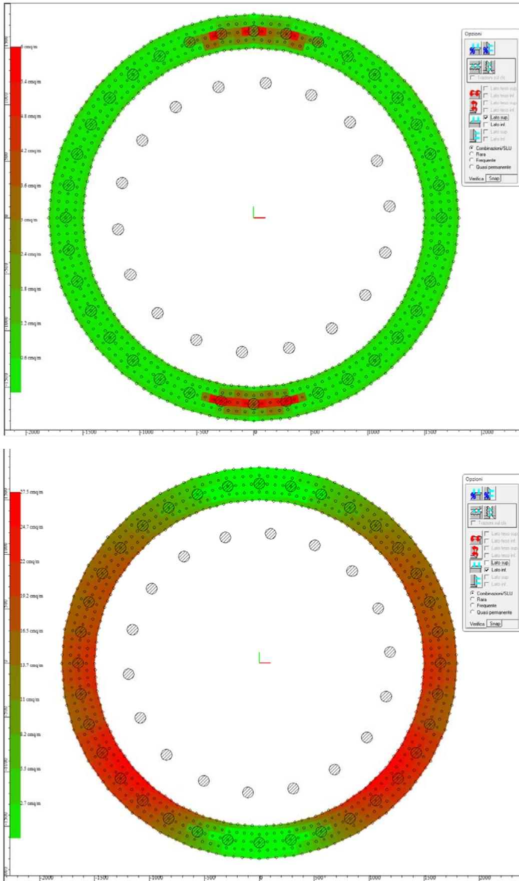
Fig. 9.1: Area minima di ferri verticali superiori e inferiori Zona 1
