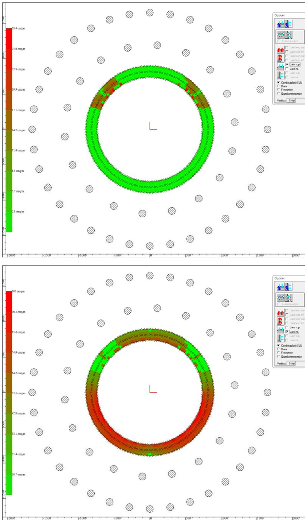
Fig. 9.9: Area minima di ferri verticali superiori e inferiori Zona 5
