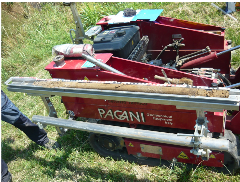
Foto n.2 : sondaggio ambientale mediante l'utilizzo dello strumento PAGANI TG 63-100
