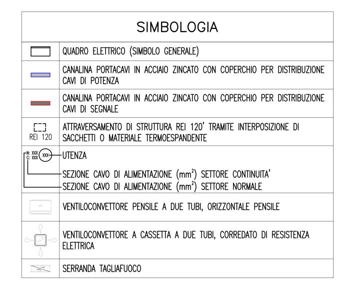
N.B. TUTTE LE MASSE ESTRANEE DEGLI IMPIANTI MECCANICI ED ANTINCENDIO SONO COLLEGATE AL NODO COLLETTORE EQUIPOTENZIALE DEL QUADRO ELETTRICO DI PIANO PIU' VICINO CON CAVO NO7G9-K SEZ. MIN. 6 mm<sup>2</sup>
