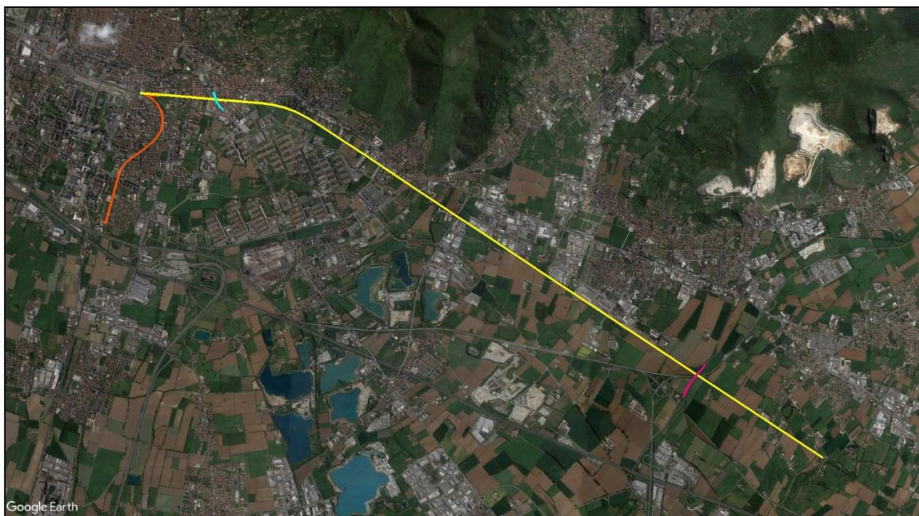
Figura 1. Posizionamento dei tracciati di progetto su ortofoto Google Earth; in arancione il cavidotto MT, in giallo la linea storica da quadruplicare, in azzurro il cavalcavia Kolbe, in magenta le opere previste al PL 92+732
