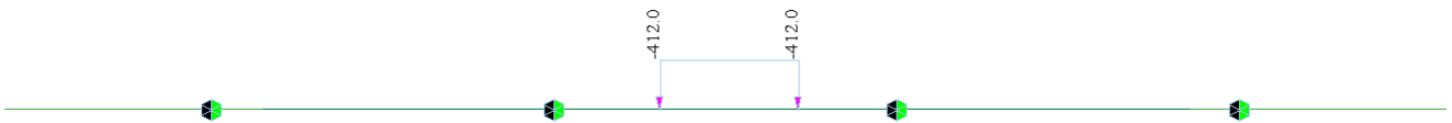
Figura 41: Disposizione dei carichi concentrati (Schema di carico 2) per massimizzazione del momento sulla campata 1
