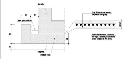
SEZIONE A-A – MONOLITE IN POSIZIONE FINALE
