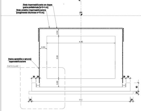
SEZIONE A-A – MONOLITE IN FASE DI VARO
