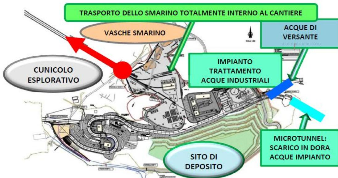
**Figura 12: principali componenti del cantiere de La Maddalena (MADMS5GIA0001AAPNOT)**
