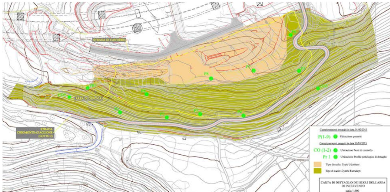
Figura 82 – Carta di dettaglio dei suoli sull'area di deposito – I punti verdi localizzano i campionamenti fatti in corso d'opera
