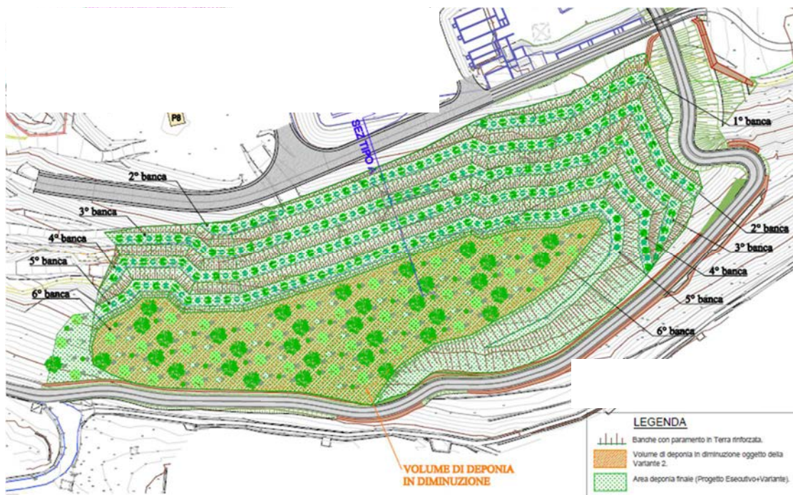
Figura 88 – Planimetria di ripristino del sito di deposito
