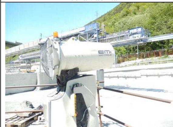
Figura 62 – Cannone a bassa pressione
