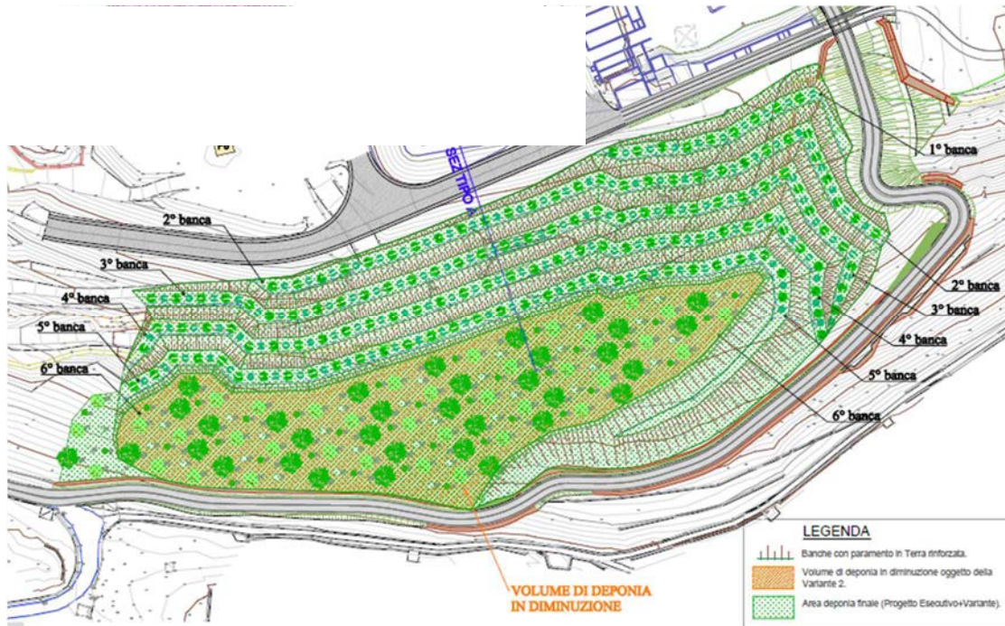
Figura 4 – Planimetria di ripristino del sito di deposito
