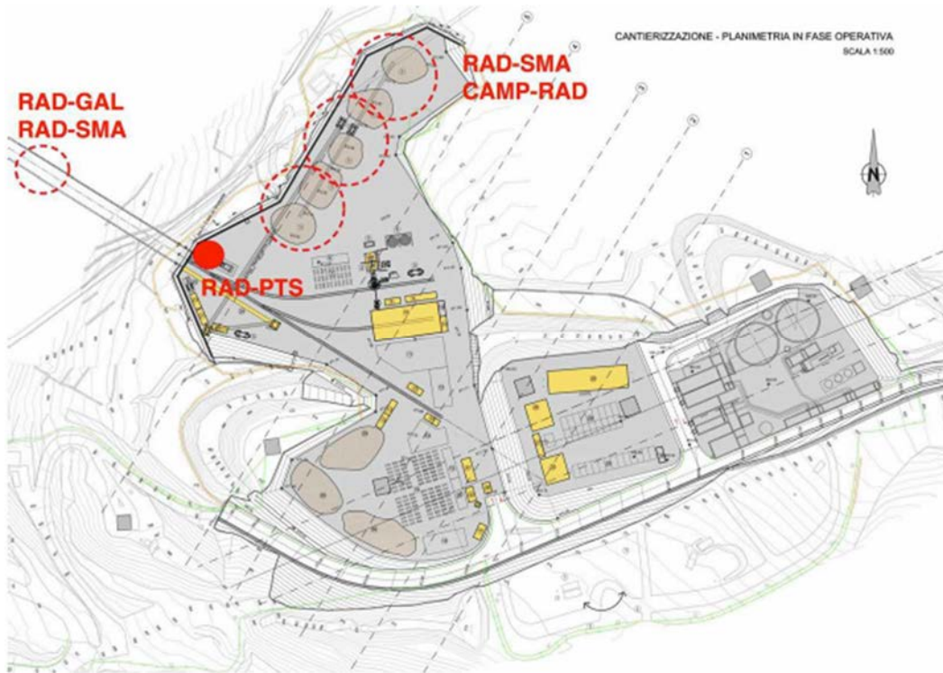
Figura 14 – Configurazione del sistema di monitoraggio delle radiazioni ionizzanti per la fase 1
