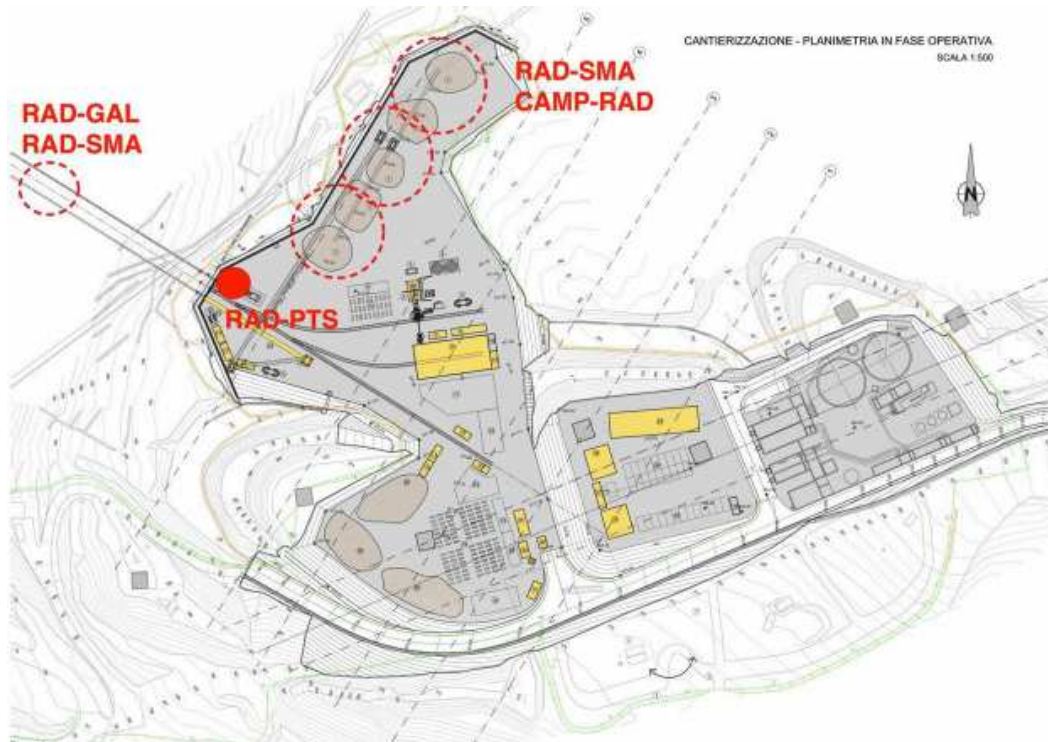
Figura 15 – Configurazione del sistema di monitoraggio delle radiazioni ionizzanti per la fase 1
