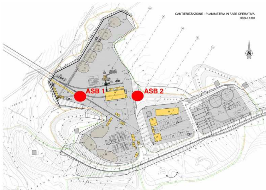
Figura 17 – Postazioni per il monitoraggio delle fibre di asbesto
