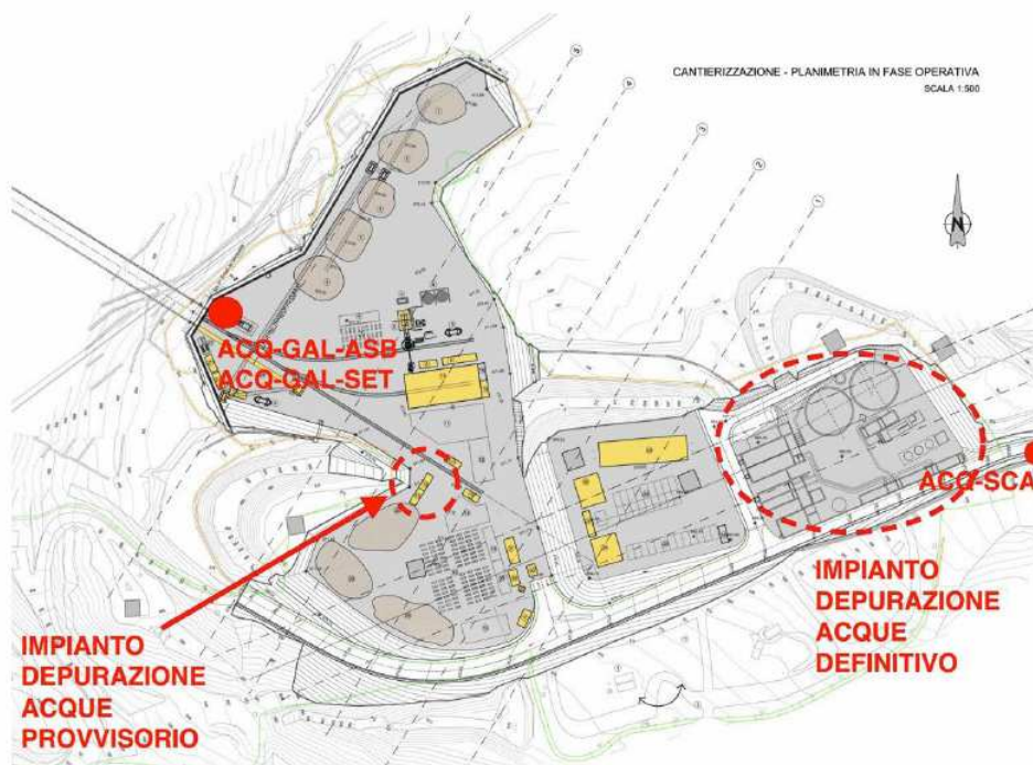
Figura 13 – Localizzazione degli impianti di depurazione provvisorio e definitivo
