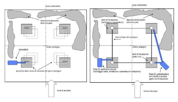
Figura 3-2 Planimetria dell'Area Sostegno (scavo di fondazione – getto e basi) – Tipologico
