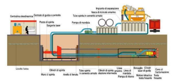
Figura 3-19 Schema della tecnica del microtunnelling
