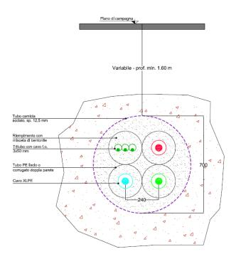
Figura 3-18 Posa in configurazione di spingitubo
