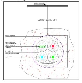
Figura 3-16 Posa in configurazione di TOC
