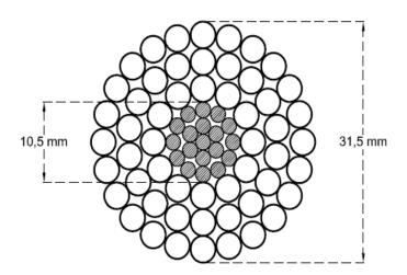
Figura 3-1 Conduttore a corda di Alluminio-Acciaio
