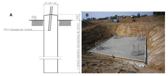
Figura 3-9 Fondazione su pali trivellati per un sostegno monostelo. A. Disegno costruttivo di un palo trivellato. B. fondazione in fase di realizzazione
