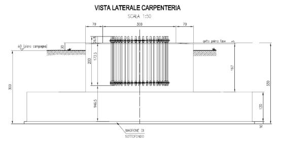
Figura 3-6 Disegno costruttivo di una fondazione superficiale tipo plinto a monoblocco per un sostegno monostelo
