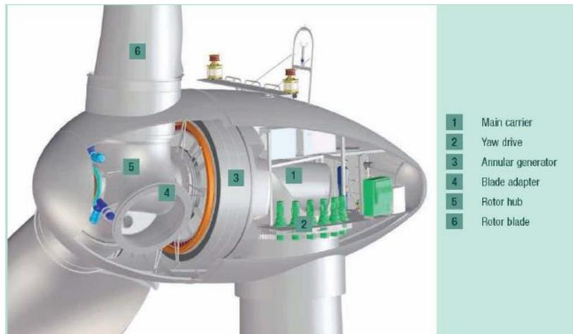
Fig. 55 - Elementi di una navicella - Fonte Enercon
