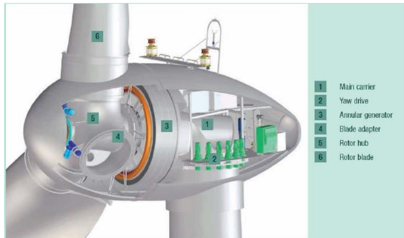
Figura 4: Caratteristiche navicella Enercon E-126- Enercon
