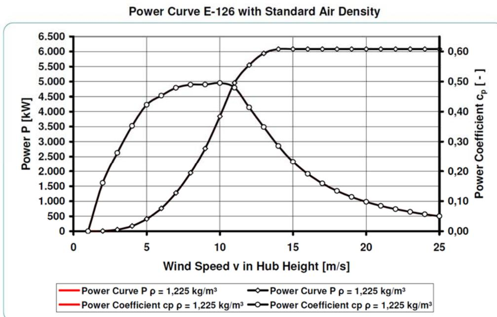
Fig.2.4: Curva di Potenza dell'aerogeneratore
