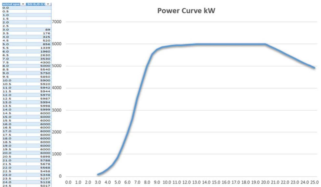
*Fig.2.1: Esempio curva di potenza per aerogeneratore tipo*
