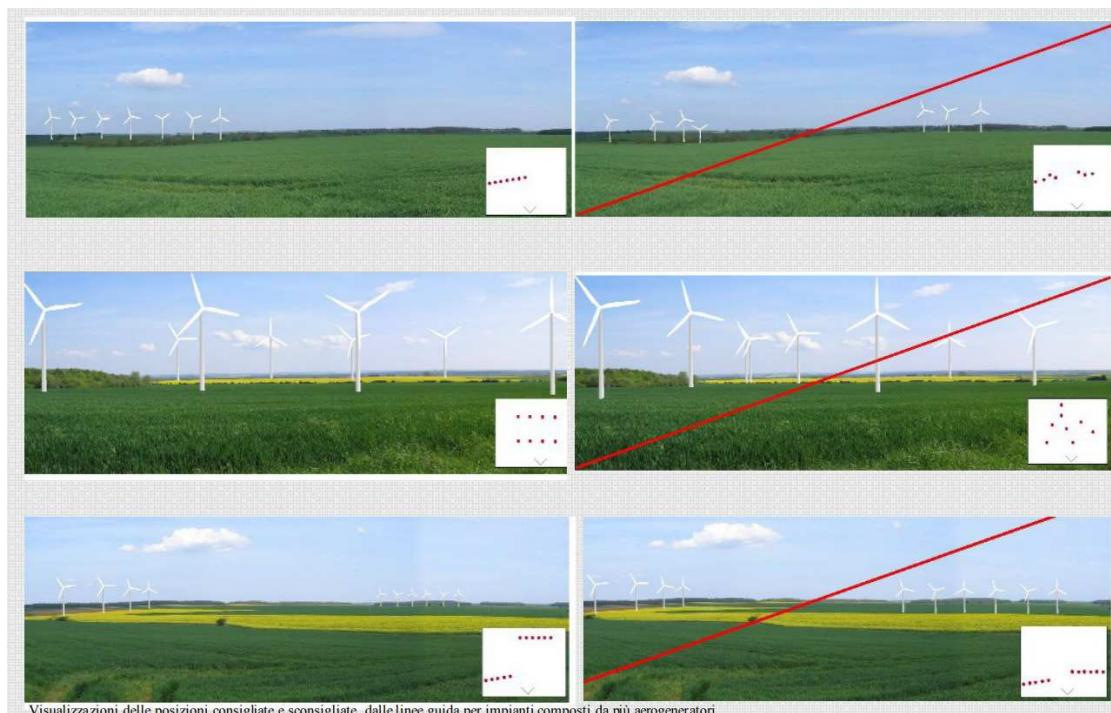
Visualizzazioni delle posizioni consigliate e sconsigliate dalle linee guida per impianti composti da più aerogeneratori
