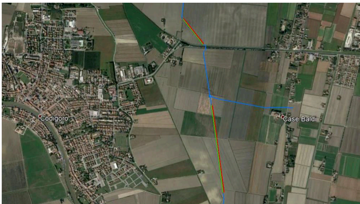
Figura 1: Varianti in Comune di Codigoro (FE): Variante a valle del Canale Galvani, in località "Proprietà Guidi" (in alto); Variante a monte del PIDI 45920/5, in località "Assunteria" (in basso) Rosso (in progetto); Verde (dismissione); Azzurro (esistente)
