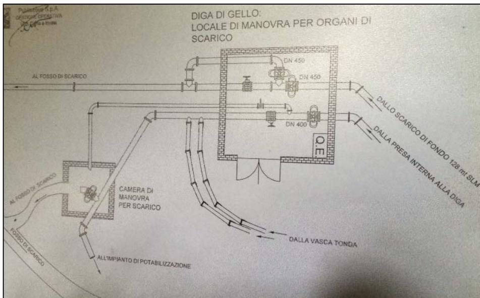
Figura 8-3: Schema di funzionamento degli organi di manovra dello scarico e derivazione.
