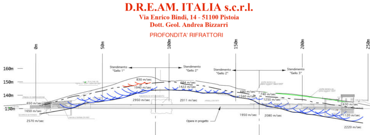
Fig. 4 – Risultato dell'indagine sismica a rifrazione onde P eseguita nel 2007 lungo la sonda destra dell'invaso e lungo il versante SO della dorsale morfologica sulla cui sommità è posto il bacino antropico della Giudea
