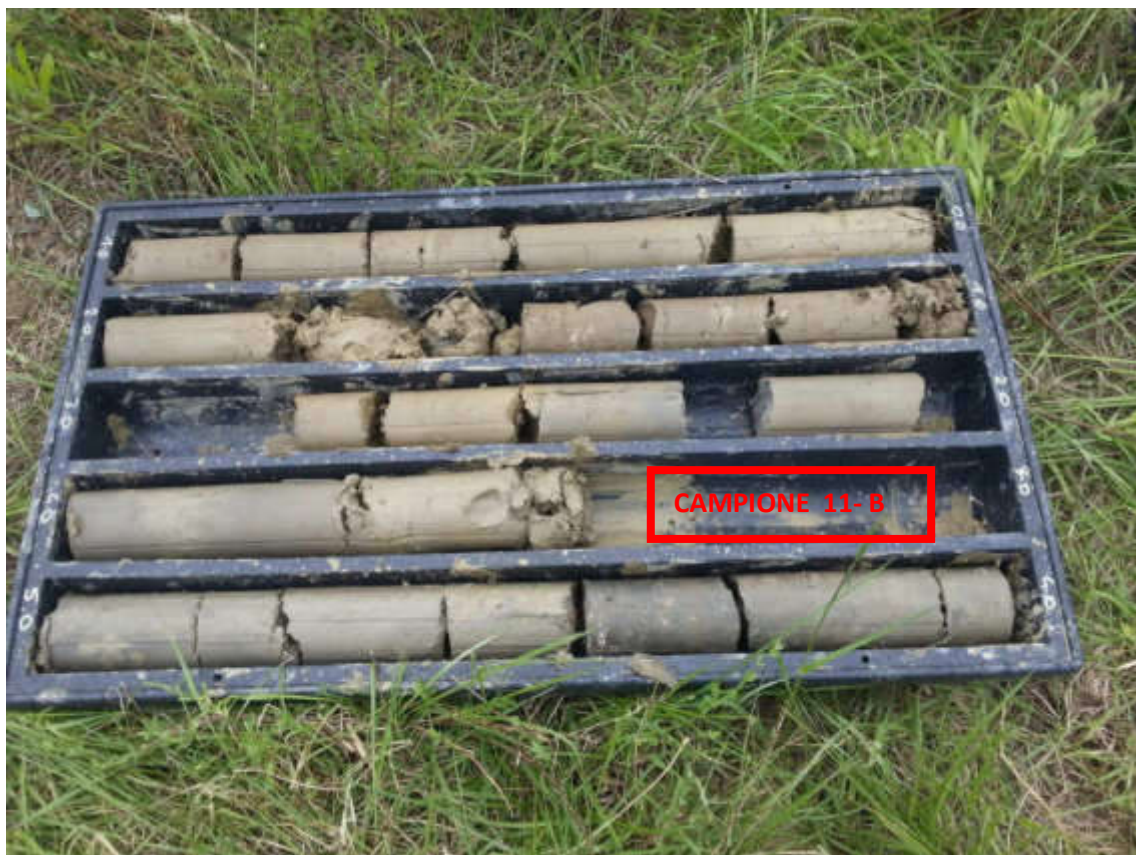
Sondaggio 11 da 0 m a 5 m
