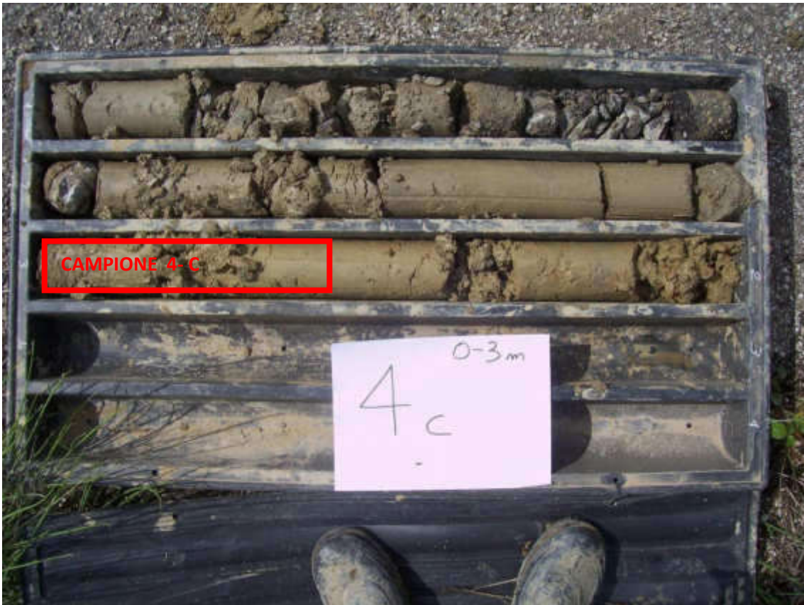
Sondaggio 4 da 0 m a 3 m
