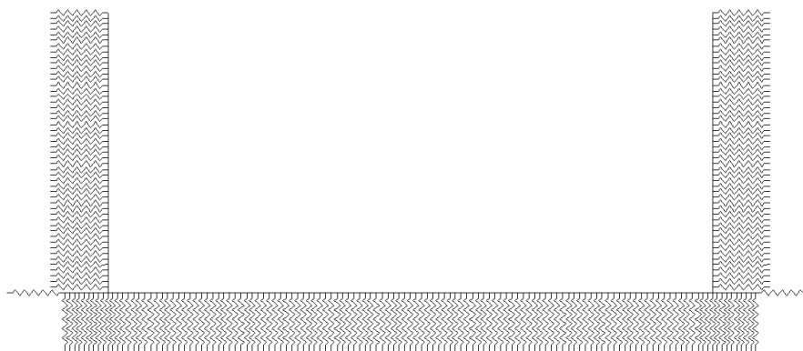
Figura 6-2 – Modellazione molle scatolare tipo 2a-c-d-e
