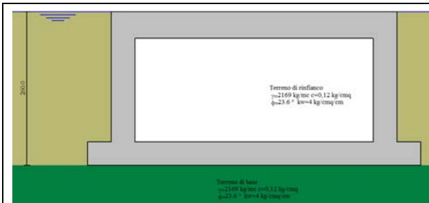
Figura 6-43 – Schema scatolare per ponte tipo IV-V
