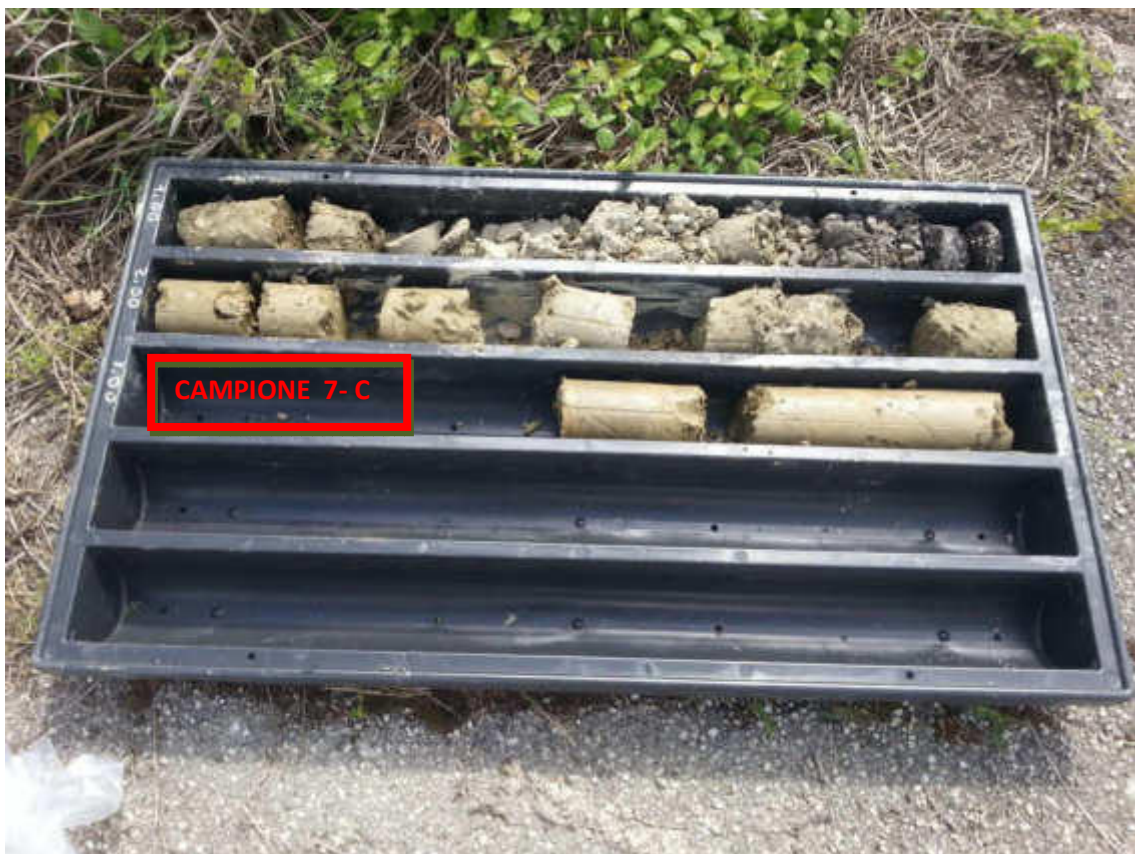
Sondaggio 7 da 0 m a 3 m
