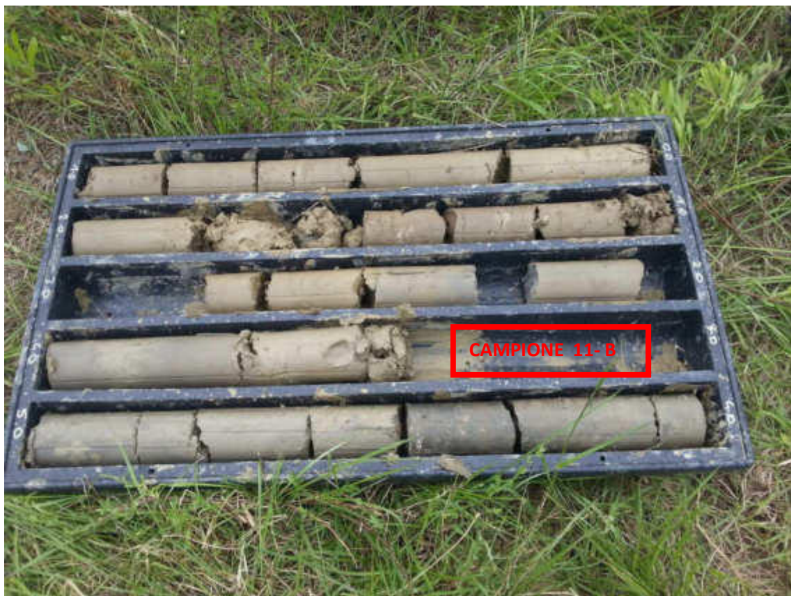
Sondaggio 11 da 0 m a 5 m
