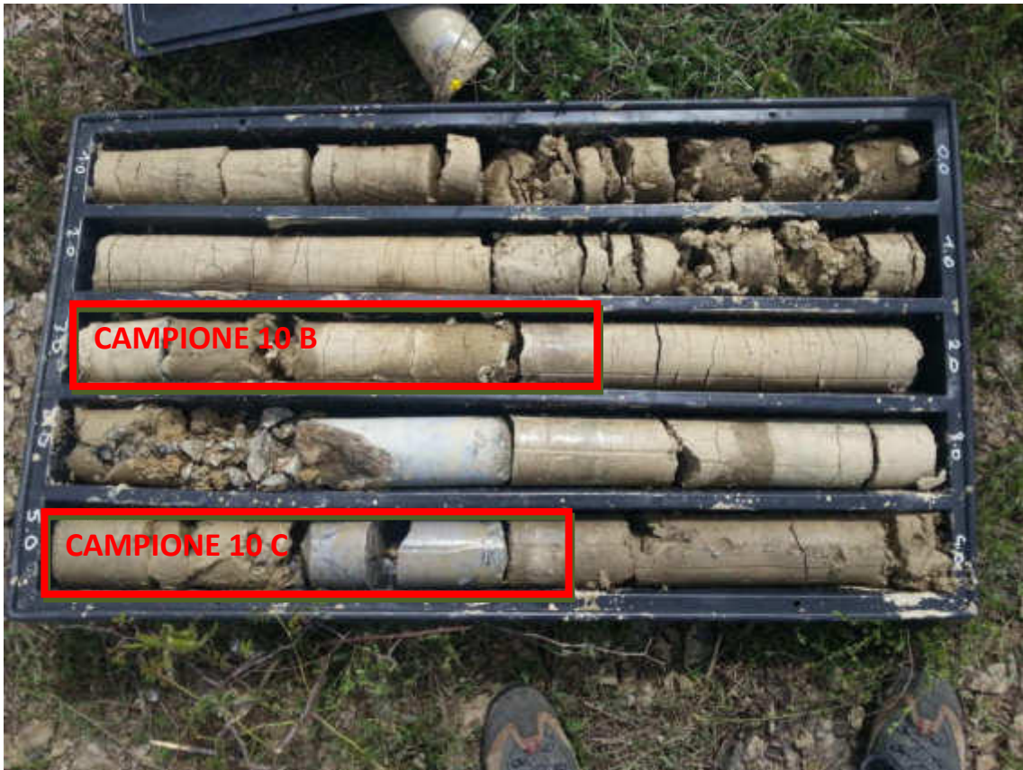
Sondaggio 10 da 0 m a 5 m
