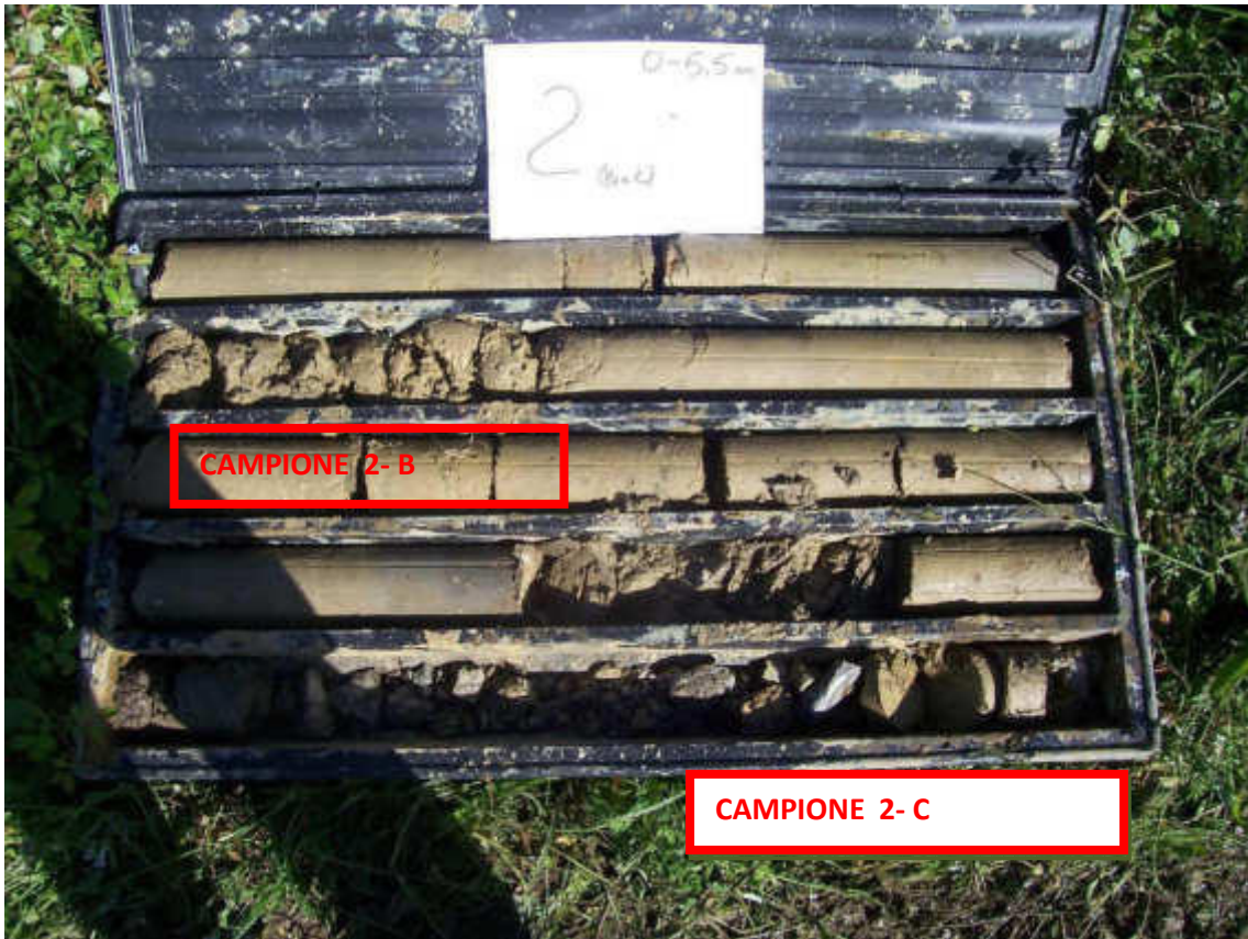
Sondaggio 2 da 0 m a 5,5 m
