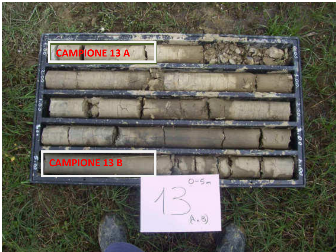
Sondaggio 13 da 0 m a 5 m
