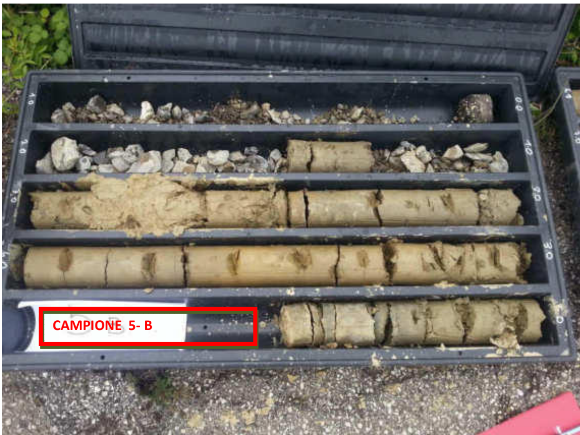
Sondaggio 5 da 0 m a 5 m
