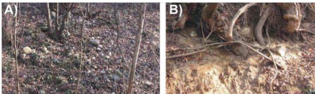
Figura 2-2 Depositi superficiali del sedime di Malpensa (comune di Somma Lombardo): a) ghiaie con ciottoli di dimensioni centimetriche e pluricentriche; b) ghiaie e ciottoli centimetrici e pluricentrici immersi in una matrice sabbiosa grossolana (Fonte: Studio geologico ed idrogeologico a supporto del Masterplan 2035 di Milano Malpensa)
