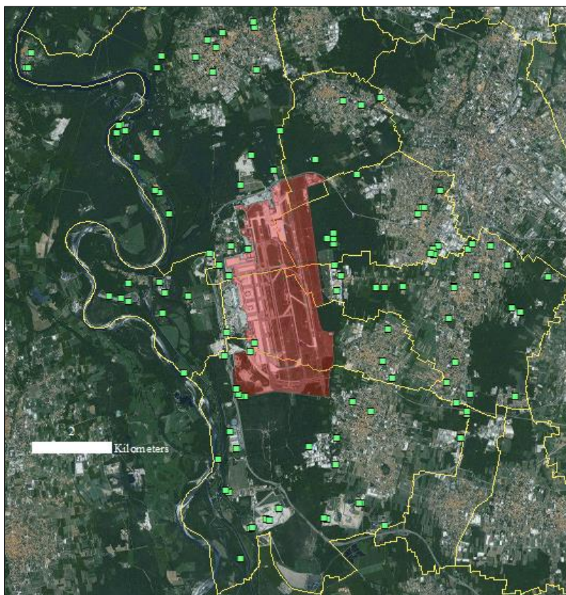
Figura 2-31 Ubicazione dei pozzi di emungimento nei comuni limitrofi all'area aeroportuale (Fonte: analisi del comportamento idrodinamico delle acque sotterranee nell'area di Malpensa – Politecnico di Milano)
