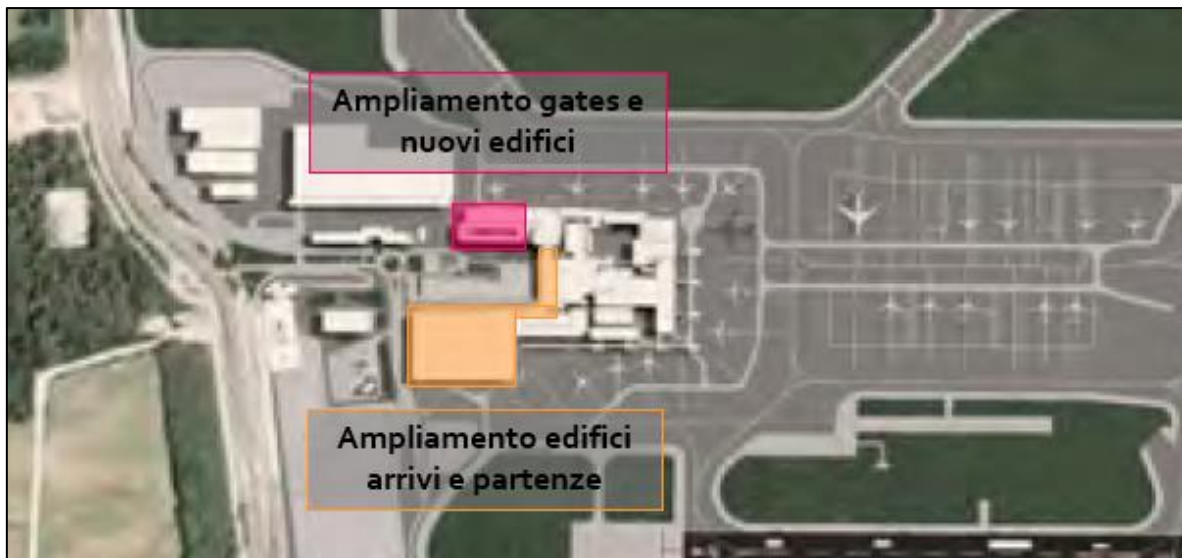
Figura 3-10 Intervento A2: Terminal passeggeri 2, opere principali
