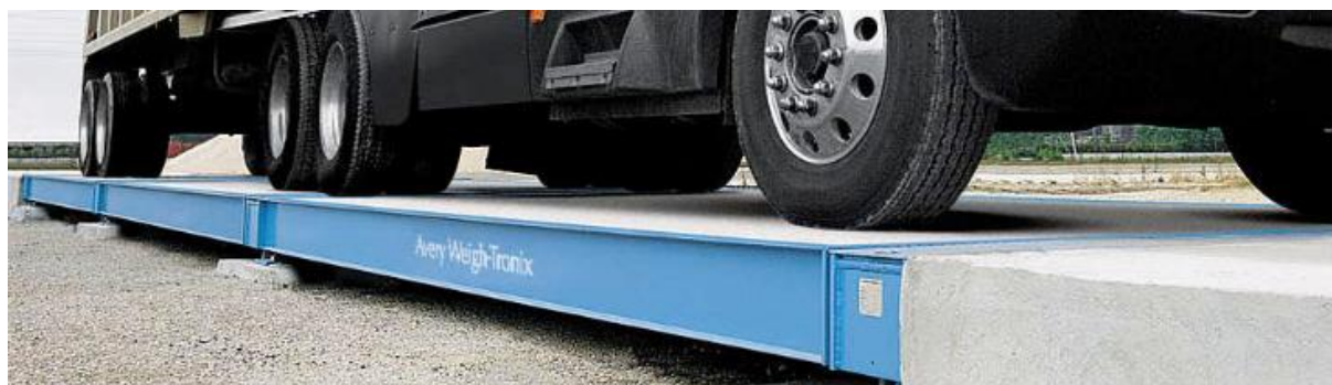
Figura 7-7 Dispositivo di pesa dei mezzi operativi
