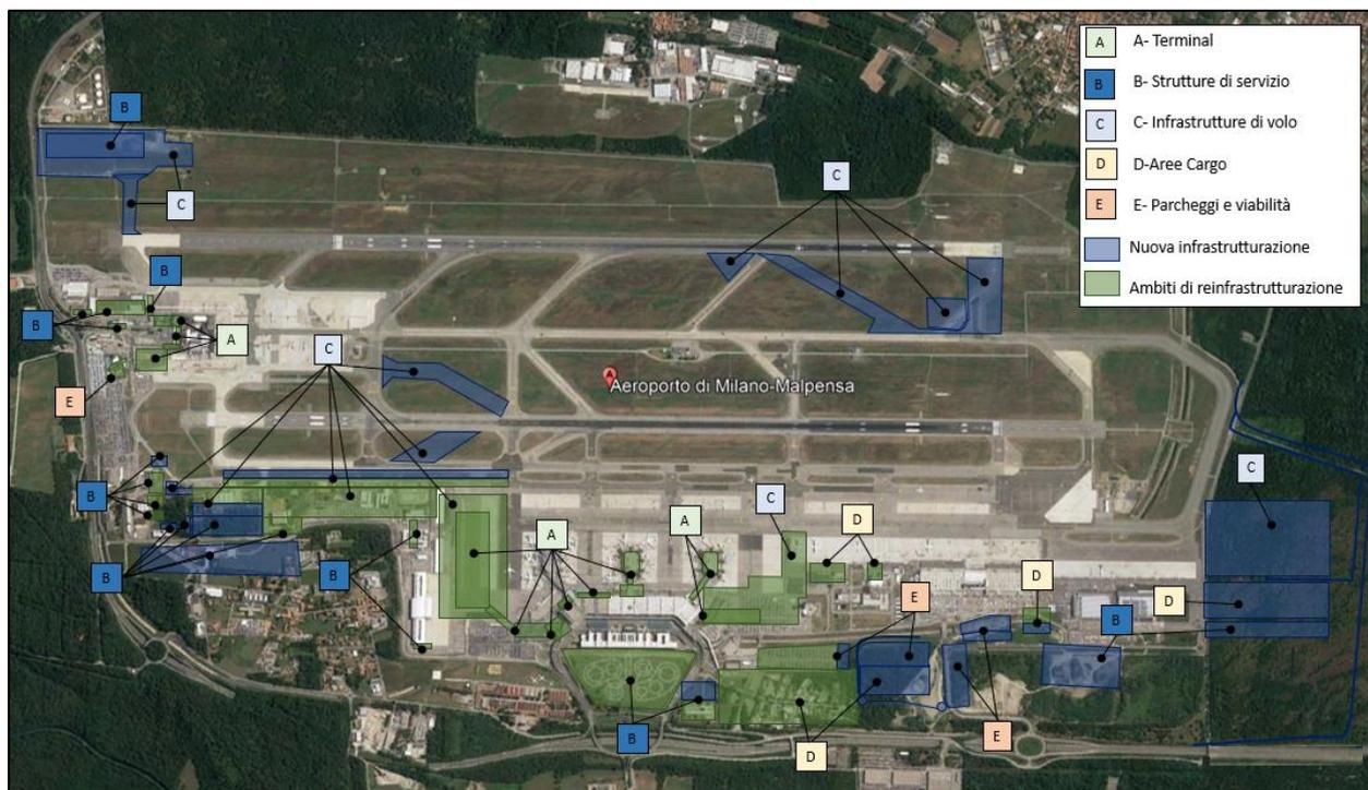
**Figura 13-1 Interventi di Masterplan per stato di artificializzazione delle aree di intervento e modalità di intervento**
