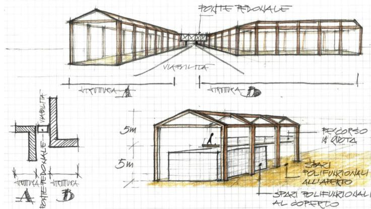
Le strutture sono concepite come strutture intelaiate ricucitura della rete sentieristica. conformate secondo l'archetipo della cascina lombarda. Al loro interno ospitano spazi al coperto da attribuire a diverse funzioni ed un percorso pedonale in quota che funge da percorso panoramico e di
