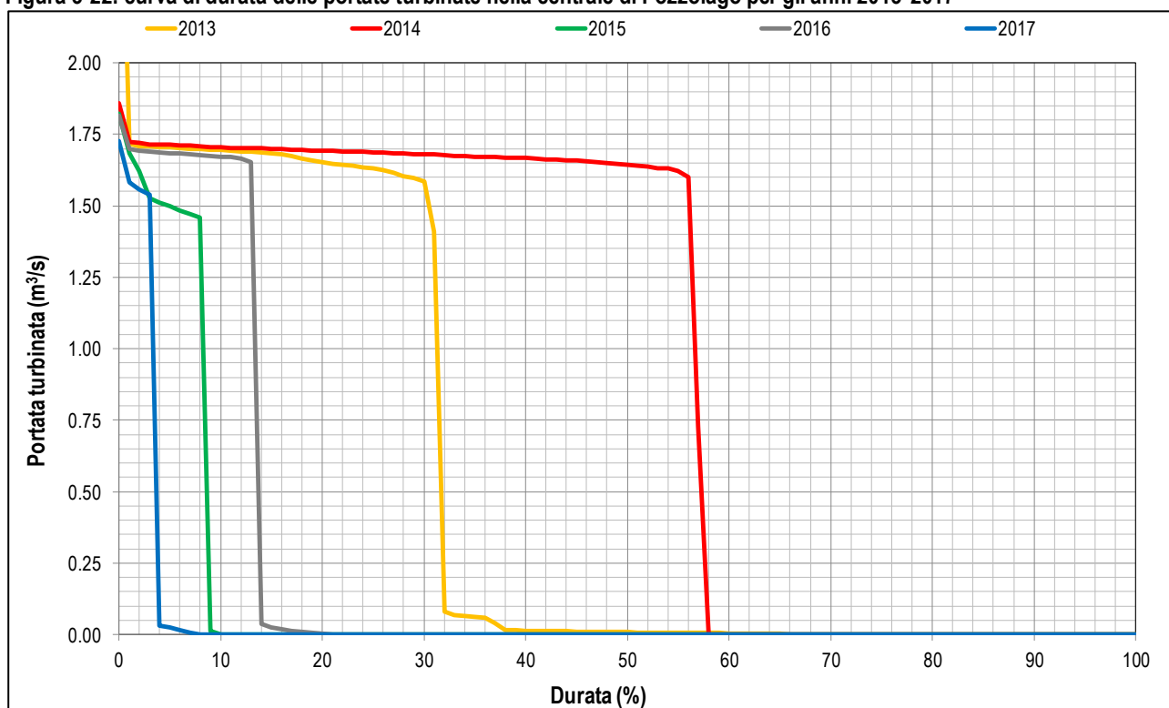
Figura 3-22: curva di durata delle portate turbinate nella centrale di Pozzolago per gli anni 2013-2017
