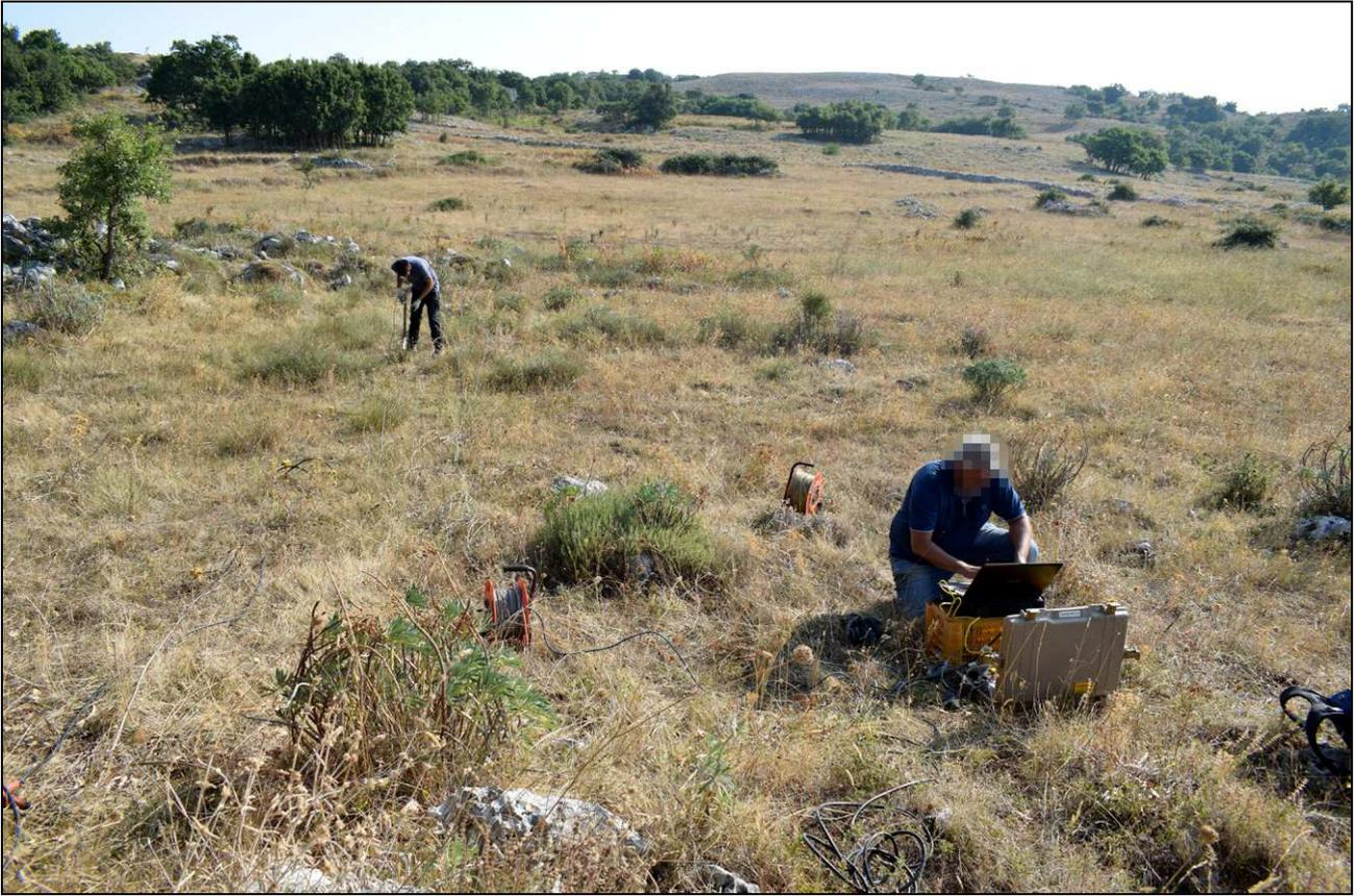
Foto n. 7 – Esecuzione sondaggio sismico S2
