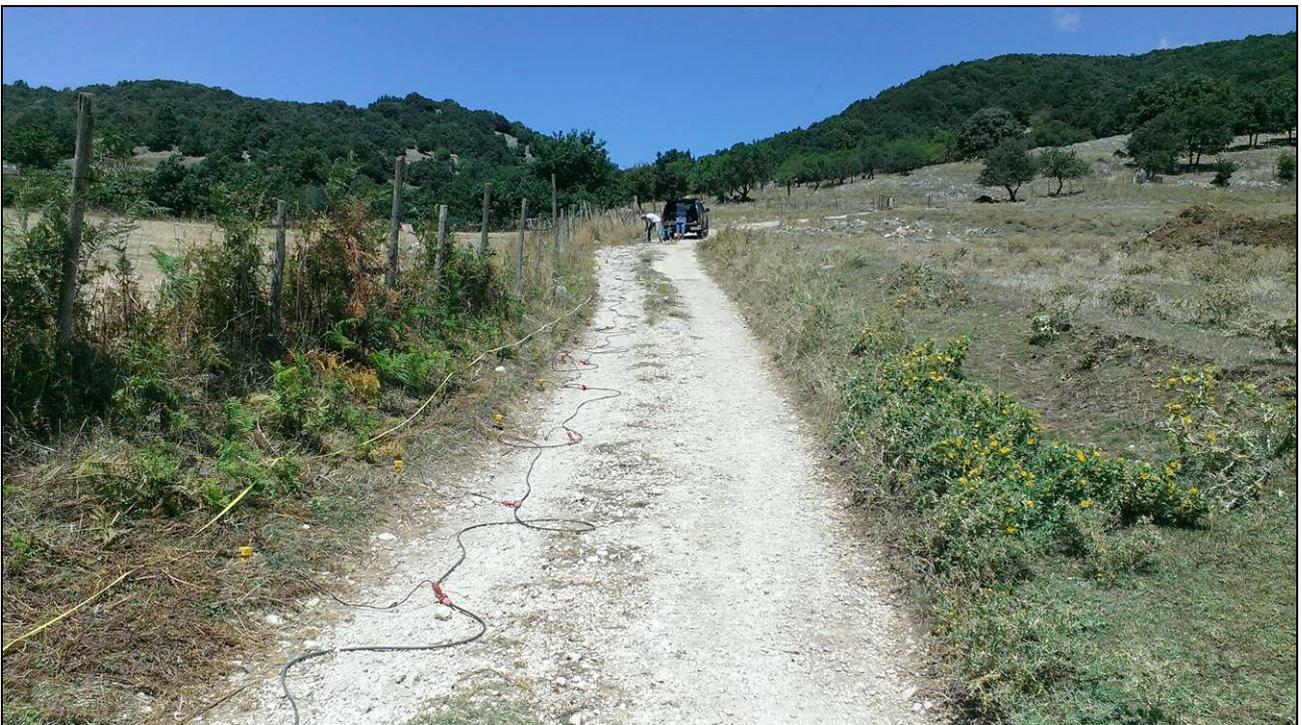
Foto n. 10 – Esecuzione sondaggio sismico S5
