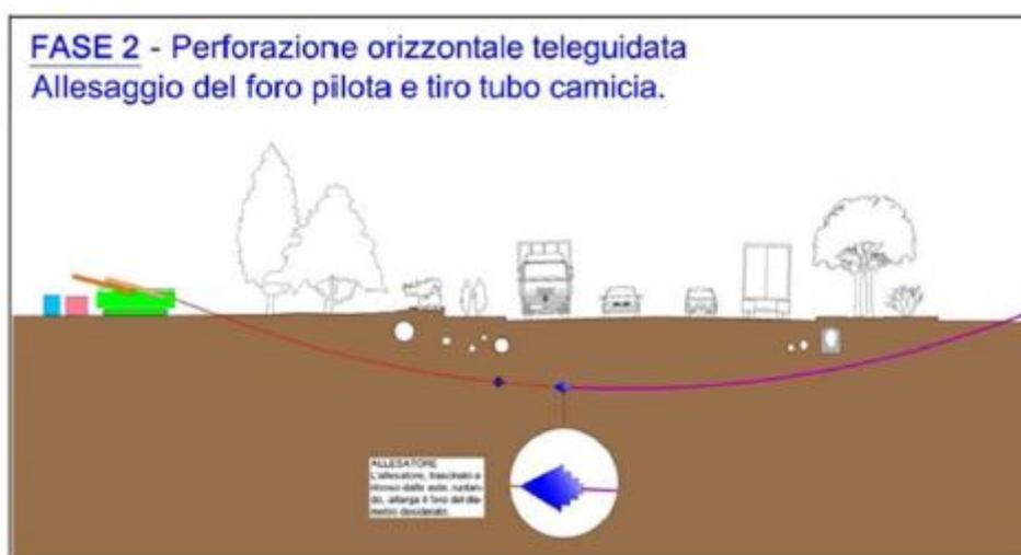
Figura 12 - Sezione tipologica della fase di perforazione teleguidata
