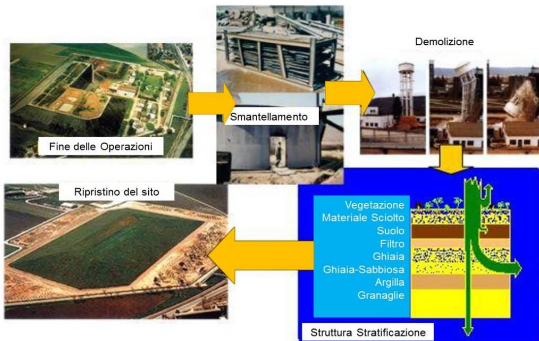
Figura I-4. Disattivazione dell'impianto di produzione di Uranio di Andujar (Jaen)
