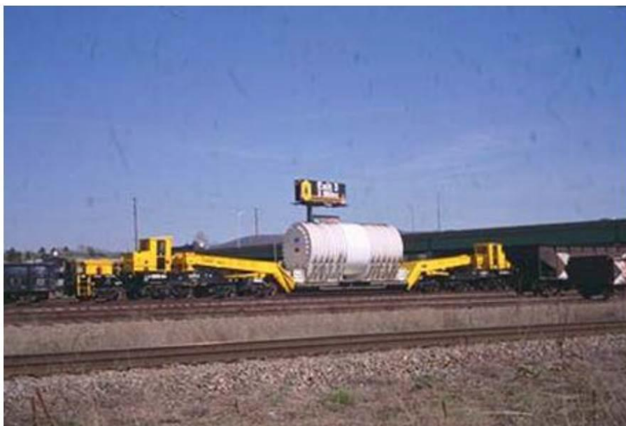
Figura I-8. Contenitore per la spedizione del contenitore del reattore Yankee Rowe su una carrozza ferroviaria
