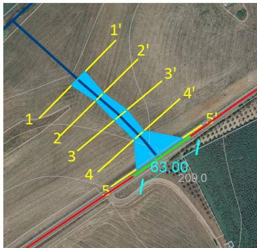
**Figura 34** - individuazione dell'interferenza del reticolo idrografico con il cavidotto MT interrato interno e rappresentazione delle aree allagabili determinate con Tr200anni. In verde il tratto di cavidotto da eseguire con TOC.
