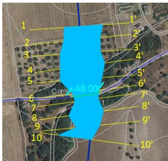
**Figura 19** - individuazione dell'interferenza del reticolo idrografico con cavidotto MT esterno interato e rappresentazione delle aree allagabili determinate con  $T_r200$ anni. In verde il tratto di cavidotto da eseguire con TOC
