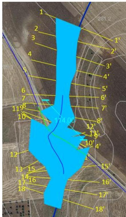
**Figura 20** - individuazione dell'interferenza del reticolo idrografico con la strada esistente e il cavidotto MT interrato e rappresentazione delle aree allagabili determinate con Tr200anni. In verde il tratto di cavidotto da eseguire con TOC.
