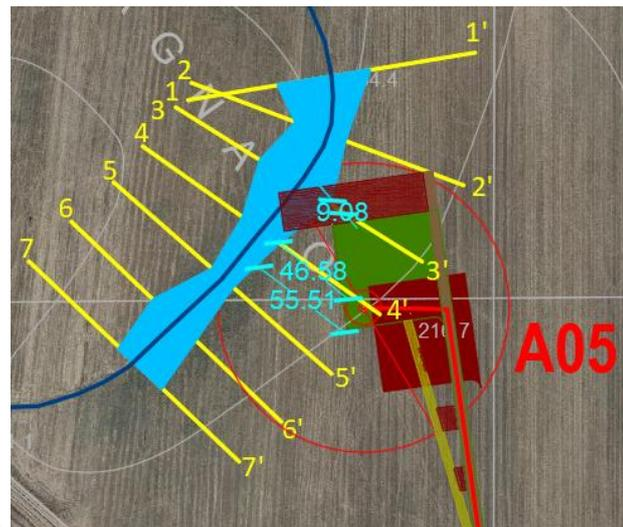
**Figura 33** - individuazione parallelismo del reticolo idrografico con l'aerogeneratore A05, il cavidotto MT interno, la strada di cantiere e la piazzola di montaggio, si evince inoltre che la piazzola di stoccaggio temporanea risulta essere interna all'area allagabile individuate ma si sottolinea che questa piazzole sono temporanee e saranno ripiestate a fine cantiere
