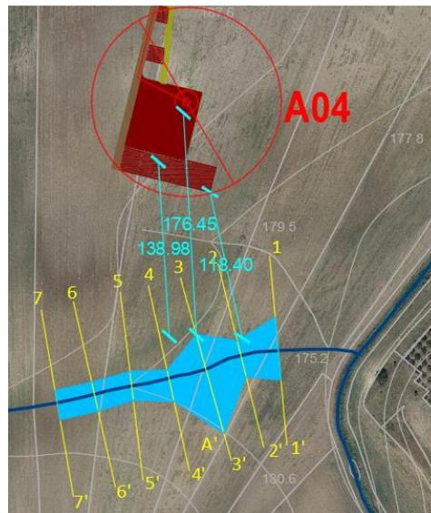
**Figura 36** - individuazione parallelismo del reticolo idrografico con l'aerogeneratore A04 e la piazzola di montaggio
