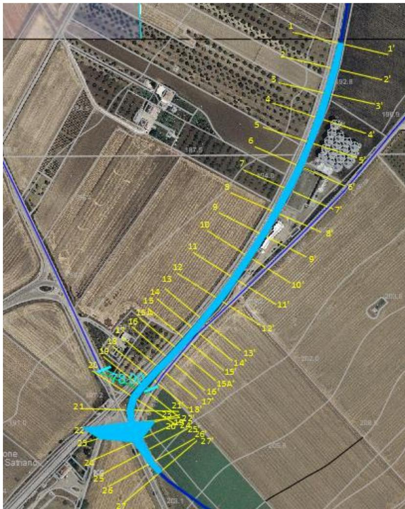
**Figura 14** - individuazione dell'interferenza del reticolo idrografico con la strada esistente e il cavidotto MT interrato e rappresentazione delle aree allagabili determinate con  $T_r200$ anni. In verde il tratto di cavidotto da eseguire con TOC.
