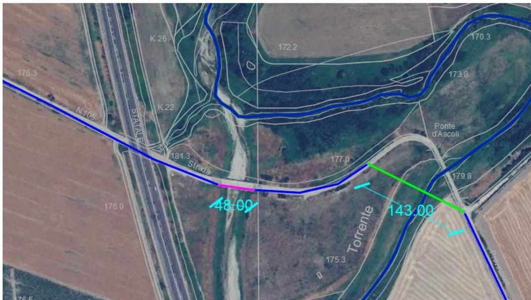
**Figura 13** – iProposta per il superamento dell'interferenza del cavidotto MT esterno con il Torrente Carapelle. Superamento del ponte romano con TOC della lunghezza di 143,00 m e superamento del ponte di nuova realizzazione con canalina staffata al ponte stesso lunghezza 48,00 m
