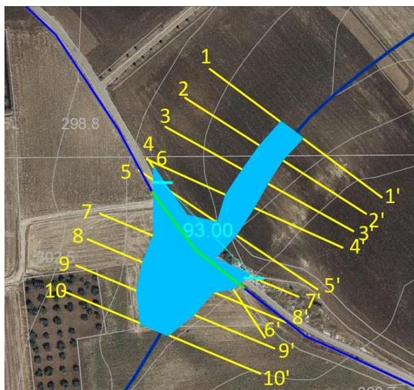
**Figura 21** - individuazione dell'interferenza del reticolo idrografico con la strada esistente e il cavidotto MT interrato e rappresentazione delle aree allagabili determinate con Tr200anni. In verde il tratto di cavidotto da eseguire con TOC.
