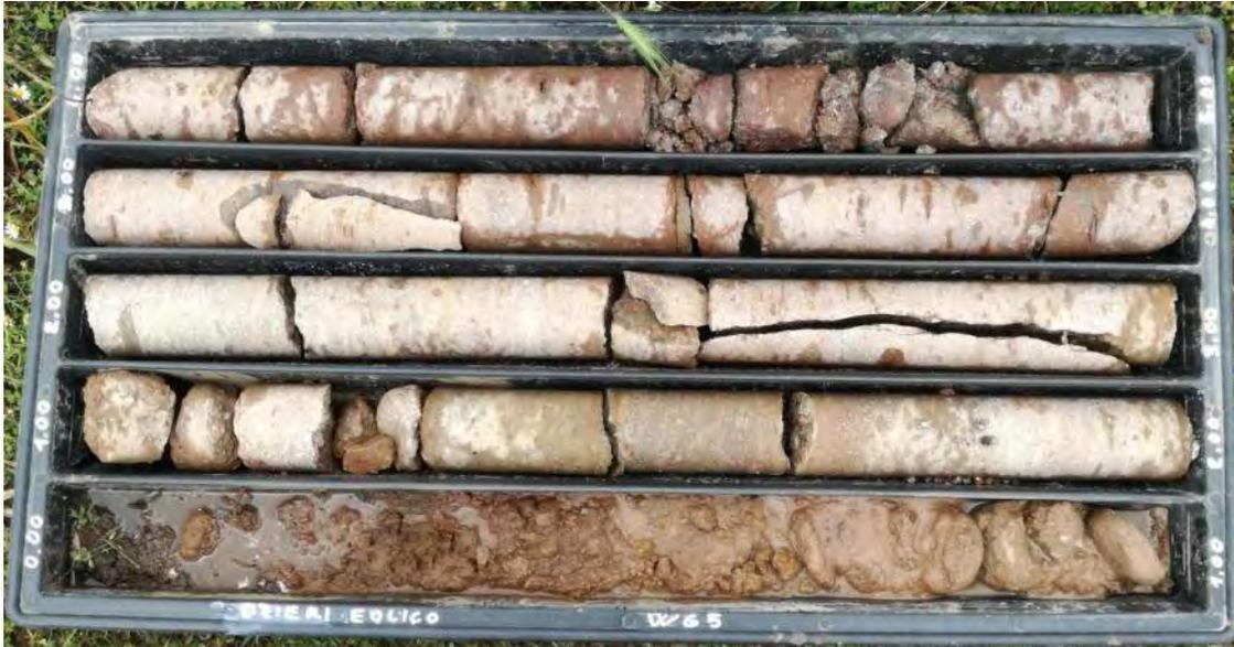
*Figura 7: Sondaggio WG5: da 0,00 m a 5,00 m.*
