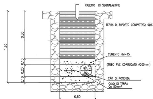
**CAVIDOTTO 150 kV IN TERRENO NORMALE
