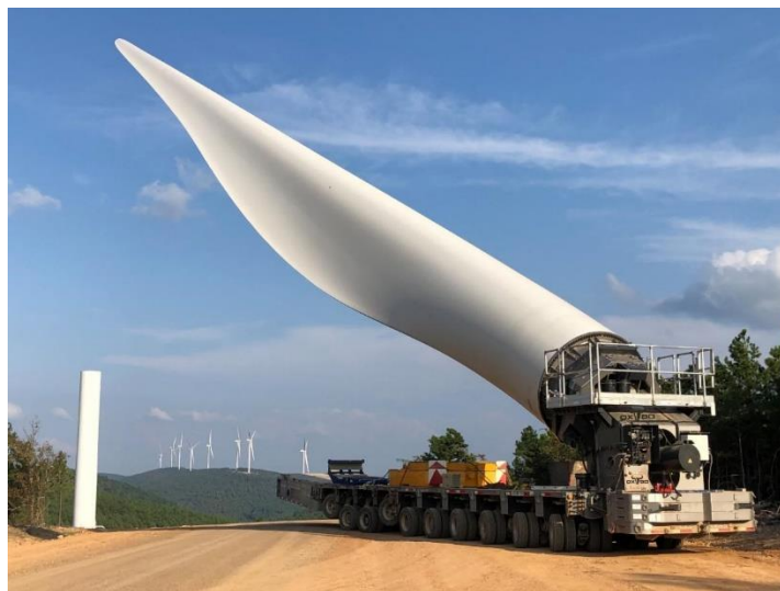
Figura 1 – Trasporto mediante Blade Lifter
