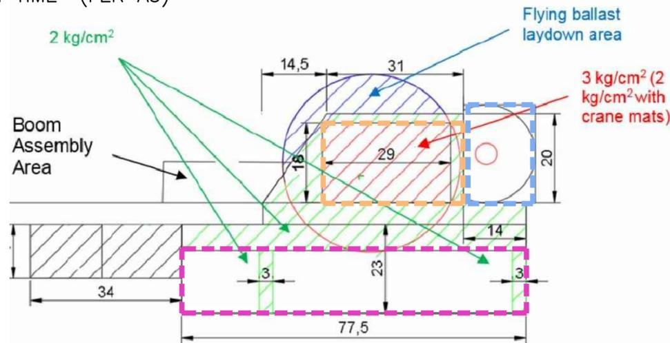
PLANIMETRIA DI DETTAGLIO DELLA PIAZZOLA DI MONTAGGIO TIPO SG 5.0-145 (FER A1-FER A2)
