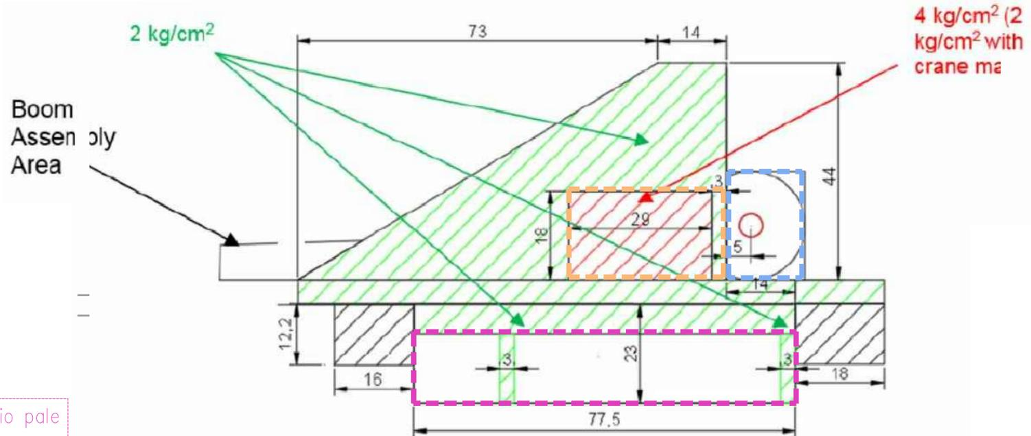
PLANIMETRIA DI DETTAGLIO DELLA PIAZZOLA DI MONTAGGIO DEL TIPO "JUST IN TIME" (FER A3)
