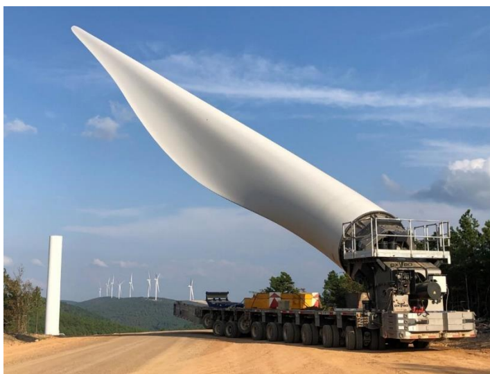
Figura 15 – Trasporto mediante Blade Lifter
