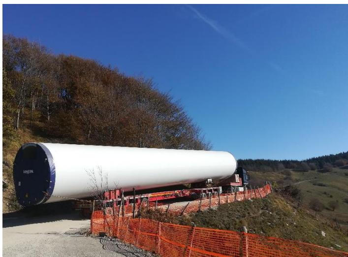
Figura 16 - Trasporto con convoglio semovente
