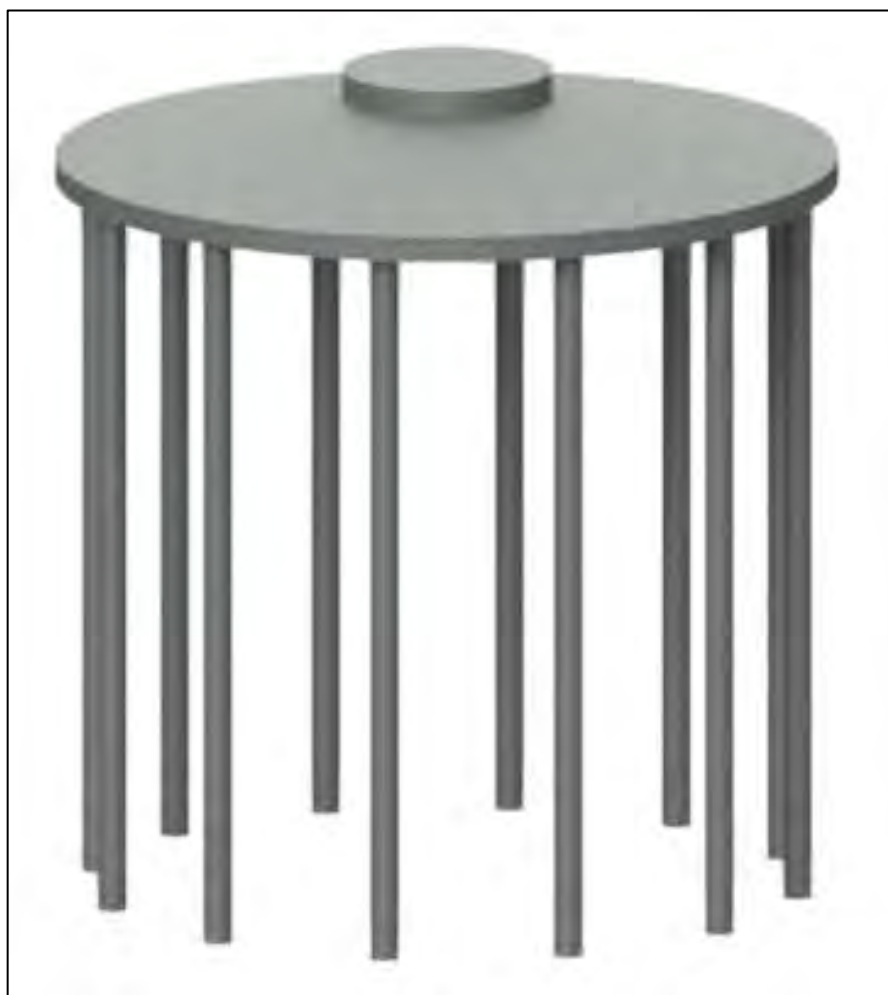
Figura 1: vista tridimensionale della fondazione dell'aerogeneratore
