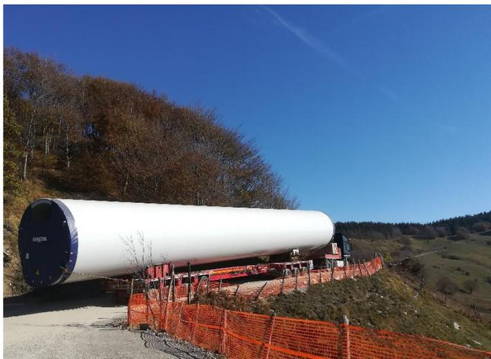
Figura 32 - Trasporto con convoglio semovente
