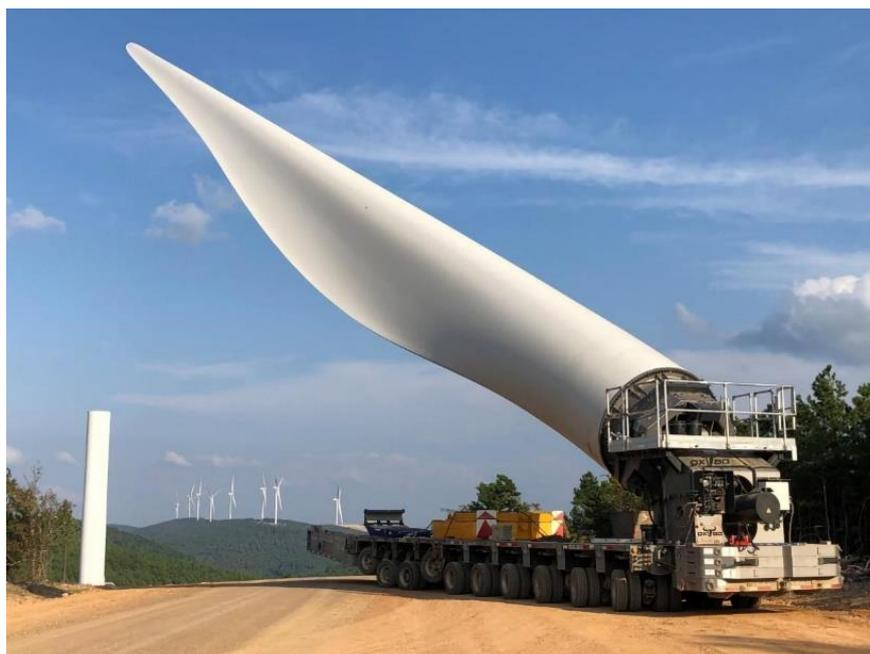
Figura 31 – Trasporto mediante Blade Lifter
