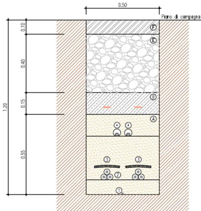
**Figura 4: sezioni tipo 1C e 2C cavidotto**
