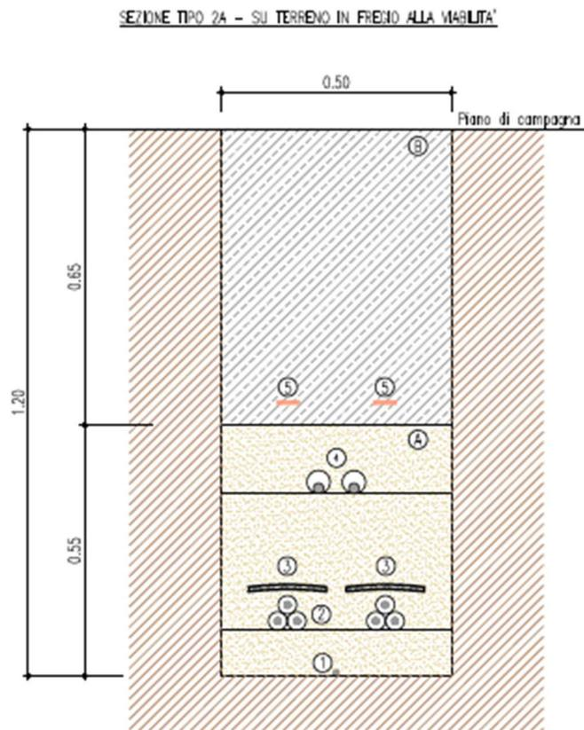
**Figura 2: sezioni tipo 1A e 2A cavidotto**
