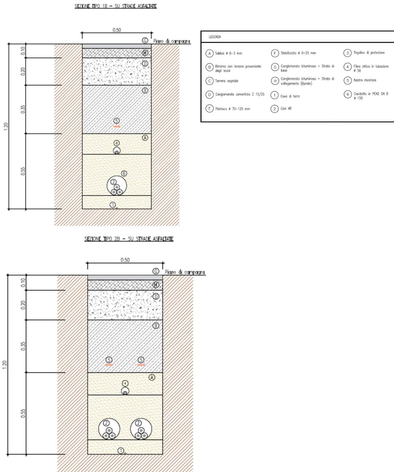
**Figura 3: sezioni tipo 1B e 2B cavidotto**
