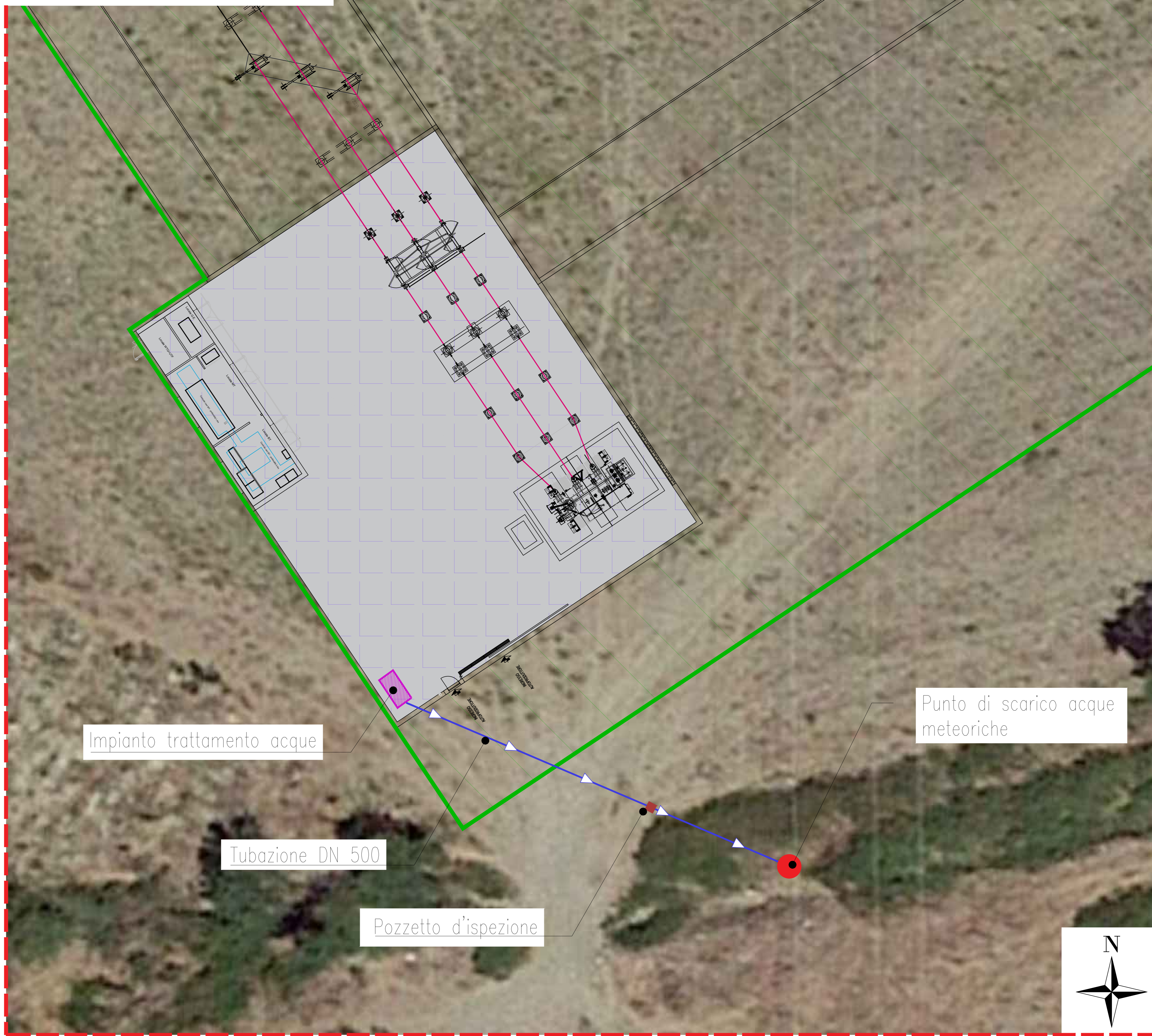
PLANIMETRIA DELLA STAZIONE ELETTRICA (SCALA 1:500)
