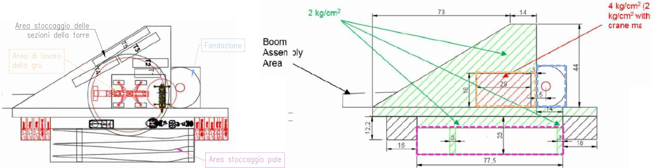
PLANIMETRIA DI DETTAGLIO DELLA PIAZZOLA DI MONTAGGIO DEL TIPO "JUST IN TIME" (FER A3)
