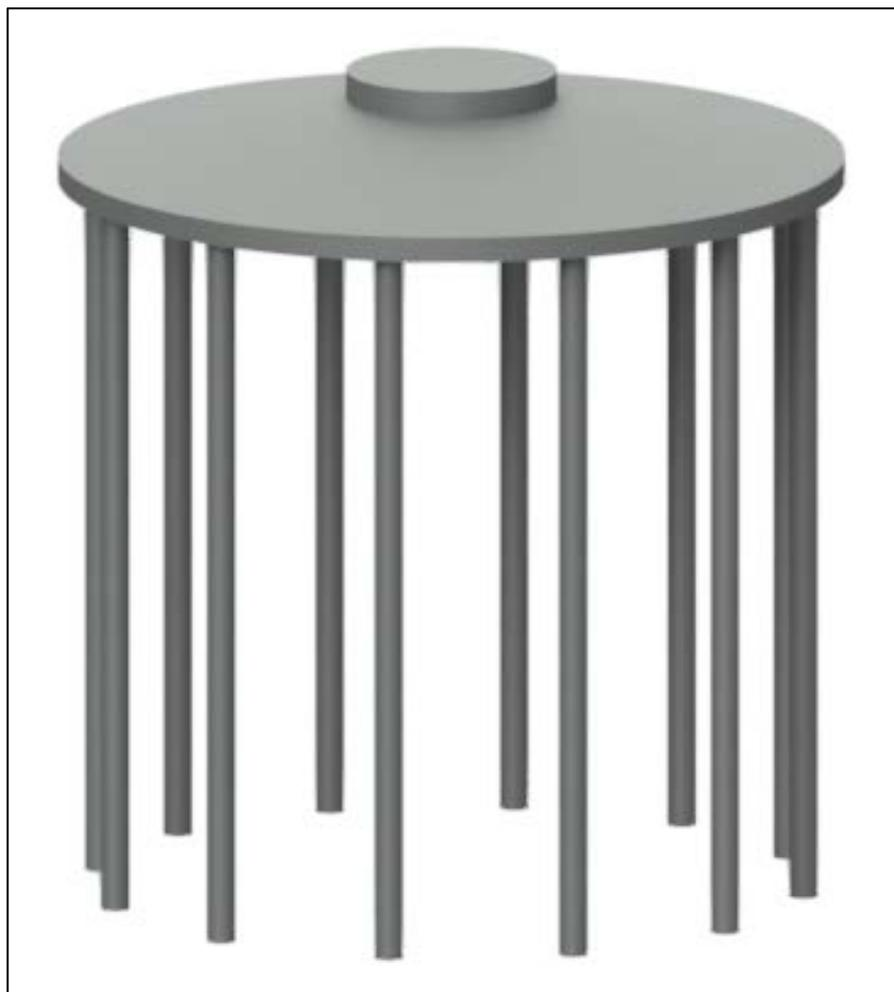
Figura 7: vista tridimensionale della fondazione dell'aerogeneratore
