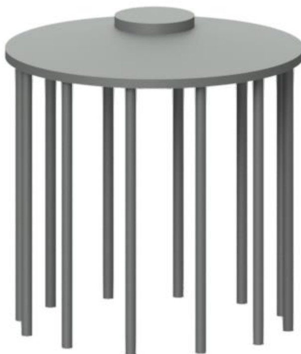
Figura 14: vista tridimensionale della fondazione dell'aerogeneratore
