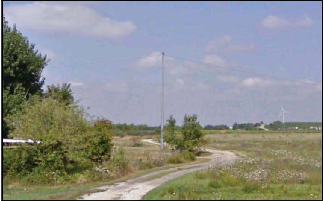
Figura 3.2.1 b Esempio di sostegno per linea MT di tipo tubolare in cavo unico elicordato
