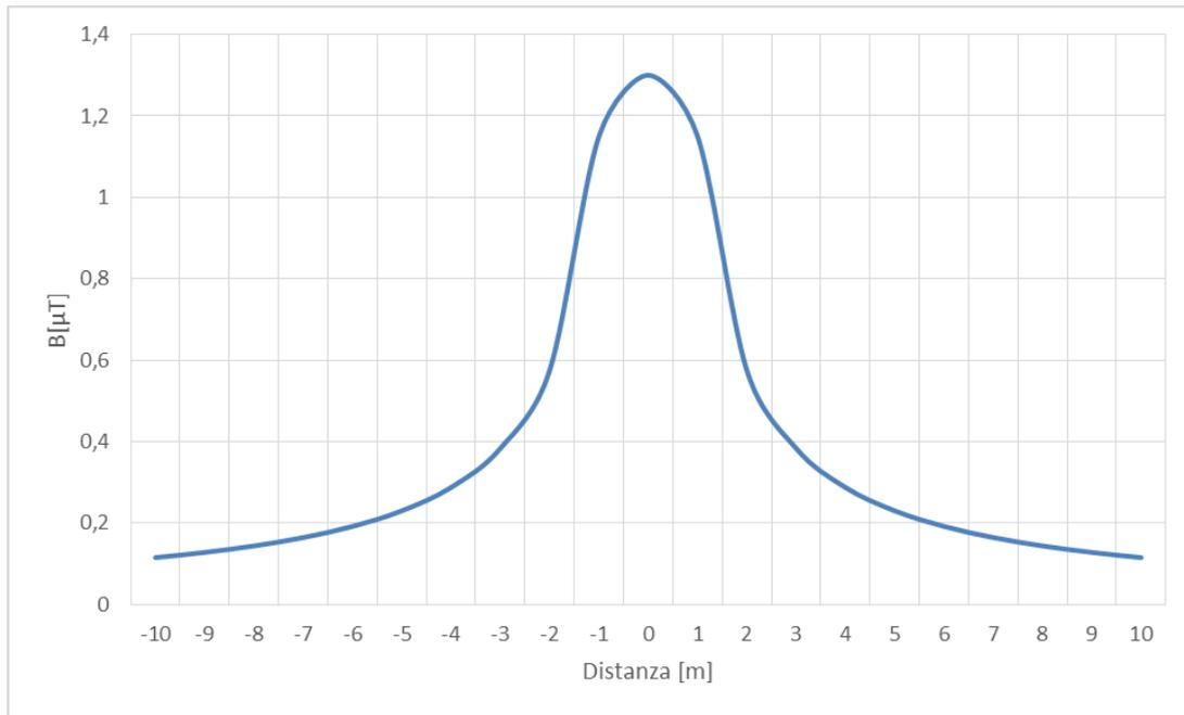
Figura 3: Andamento dell'induzione magnetica prodotta dalla linea in cavo
