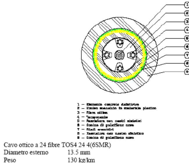
Figura 4: Schema cavo f.o.
