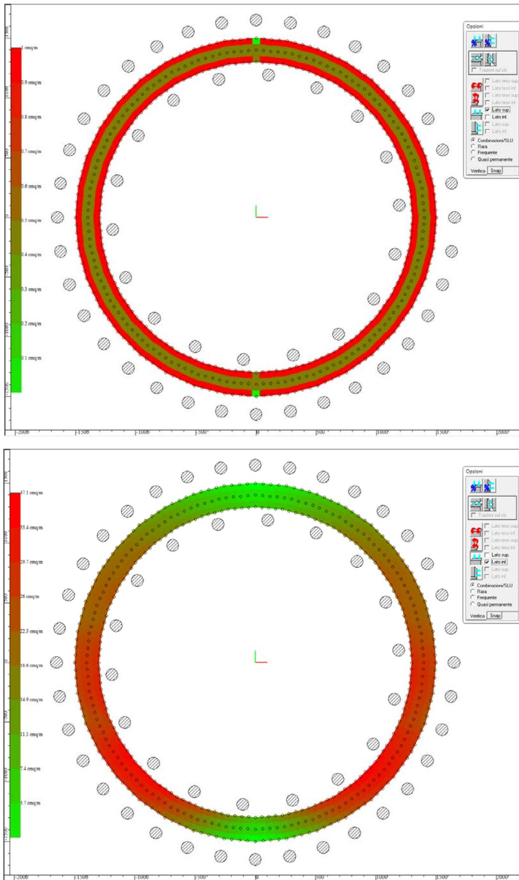
Fig. 9.3: Area minima di ferri verticali superiori e inferiori Zona 2
