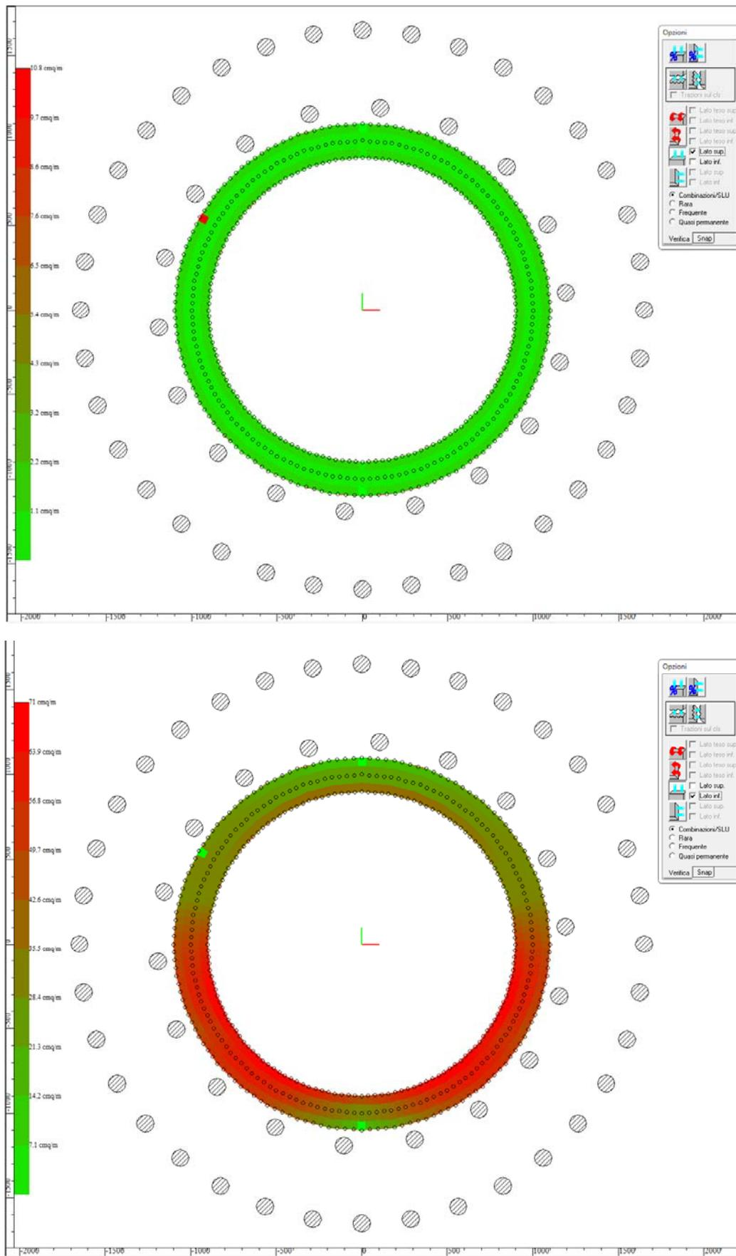
Fig. 9.7: Area minima di ferri verticali superiori e inferiori Zona 4
