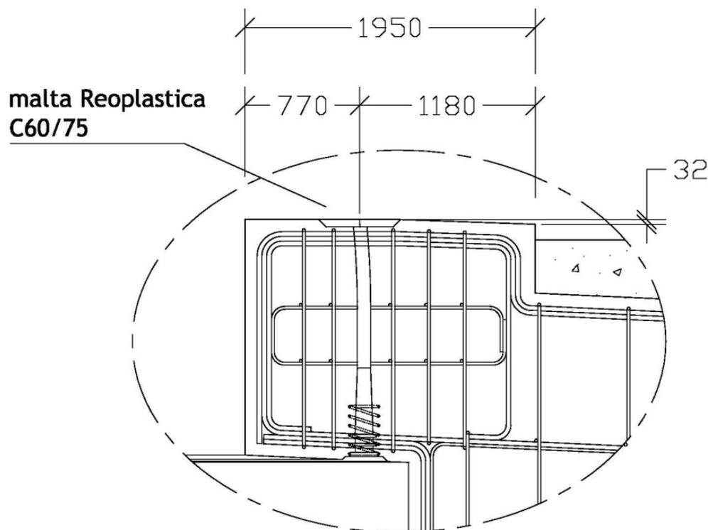
Fig. 2.1: Sezione di interfaccia Torre-Plinto
