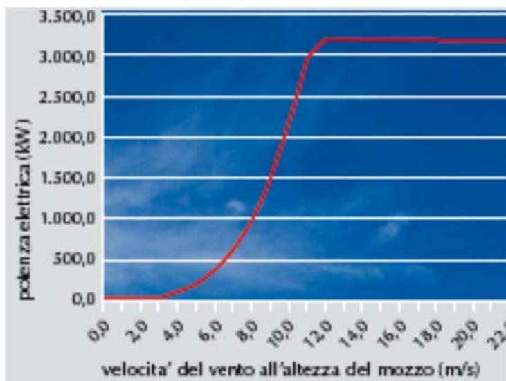
Fig.6.15: Curva di Potenza dell'aerogeneratore
