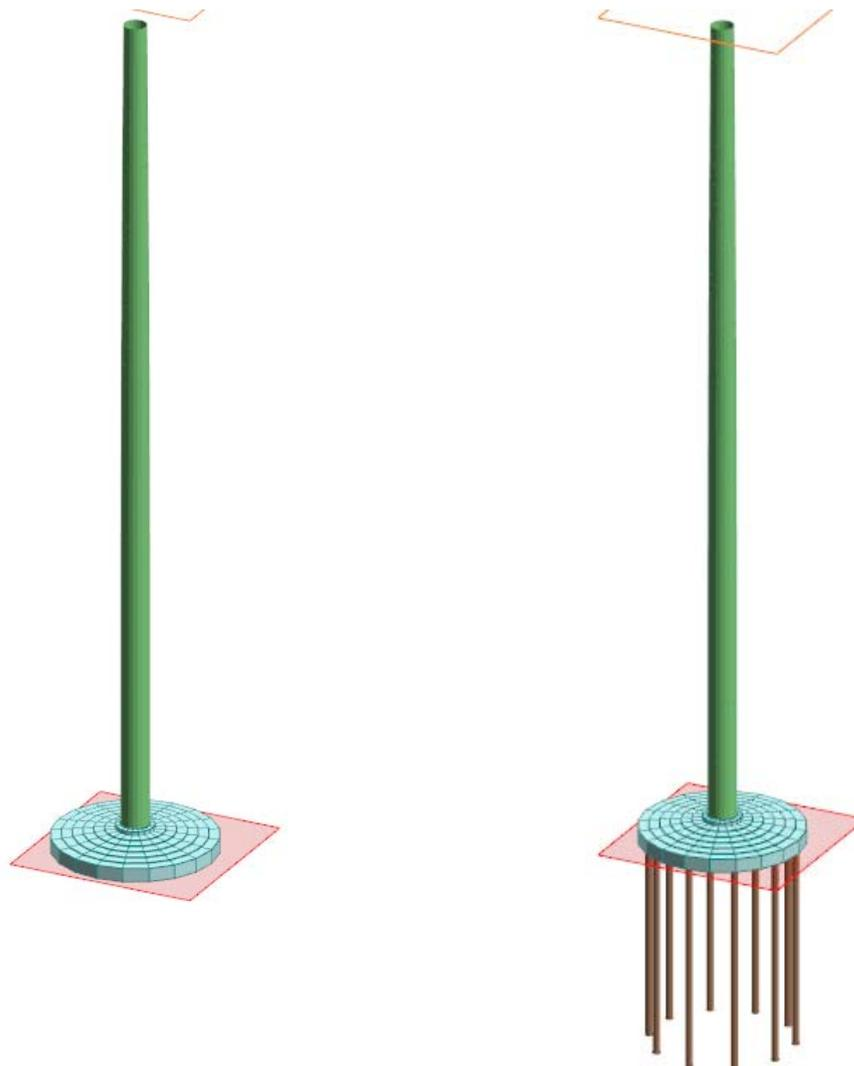
FIGURA 9: MODELLO SOLIDO DEL COMPLESSO TORRE IN ACCIAIO / BLOCCO DI FONDAZIONE CASO SOLO PLATEA E CASO PLATEA CON PALI
