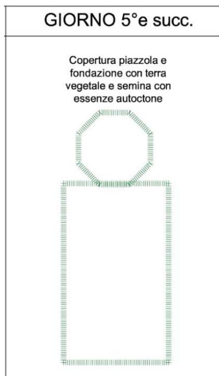
Fasi di smontaggio degli aerogeneratori
