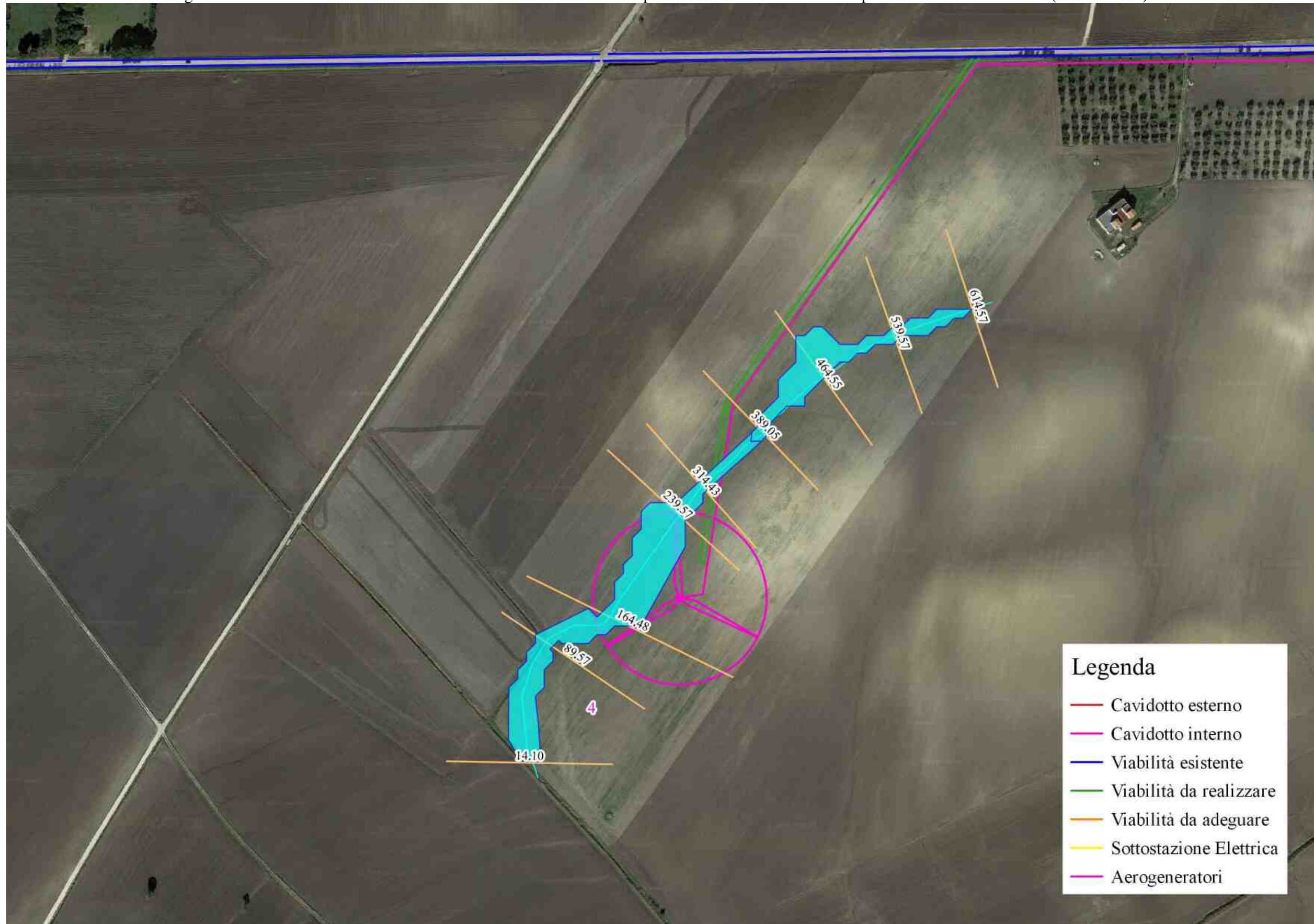
Figura n.47 - Planimetria con individuazione delle sezioni e delle aree potenzialmente interessate dalla portata avente tr = 200 anni (Scala 1:4000)
