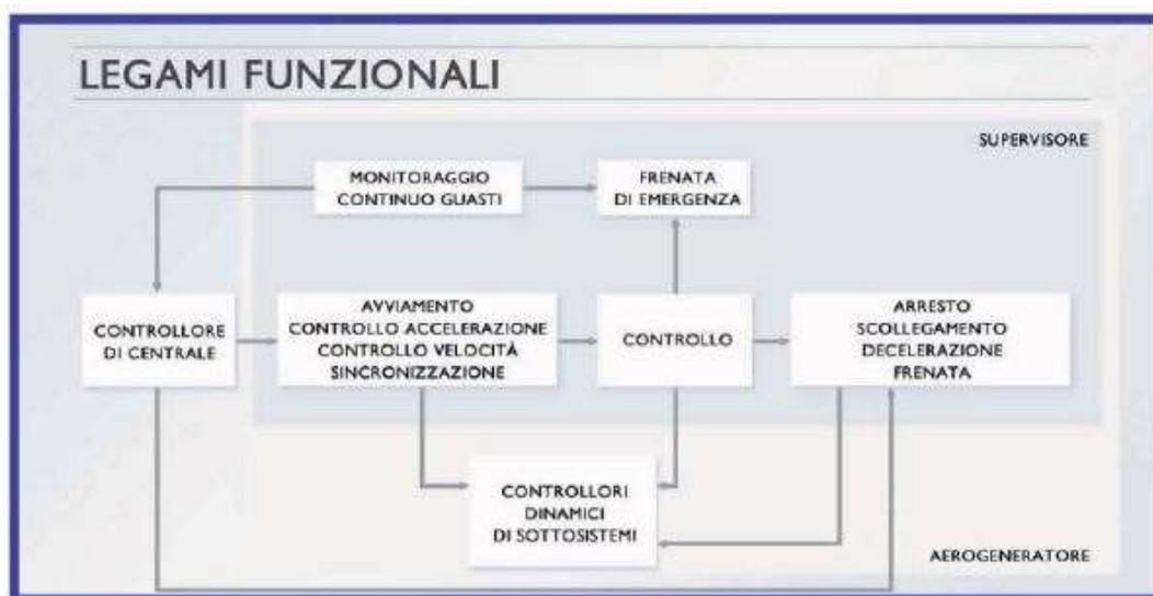
**Figura 4 - Schema funzionale del sistema di controllo e supervisione dell'aerogeneratore**
