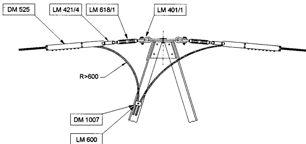
Nota: Le quantità dei morsetti bifilari DM 1007 e delle staffe di fissaggio LM 600 per la discesa della fune di guardia alla scatola di giunzione sono riportate negli schemi di montaggio dei sostegni unificati.
